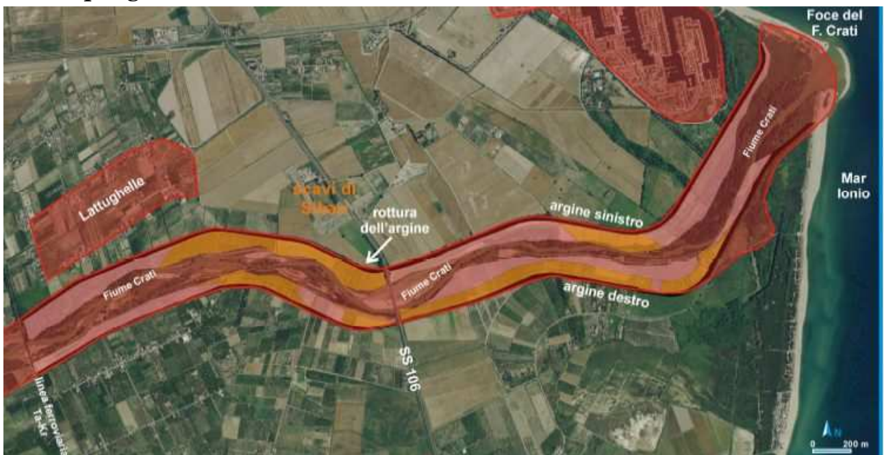
Figura 2.6. Particolare carta PAI nella quale viene indicato il punto di rottura dell'argine che ha portato alla inondazione dell'area degli scavi di Sibari, molto prossima all'area di interesse.
