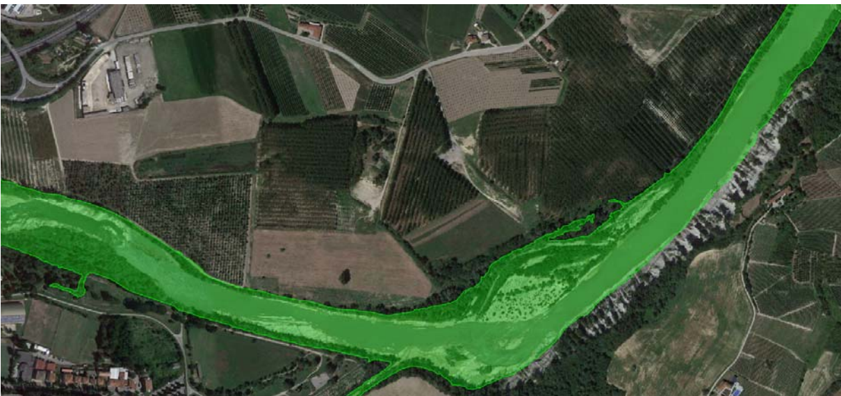
Figura i.4. Area di esondazione del F. Tanaro relativa alla situazione di progetto con sezione parzializzata e portata pari a 750 m 3 /s (portata massima contenuta all'interno dell'alveo inciso).
