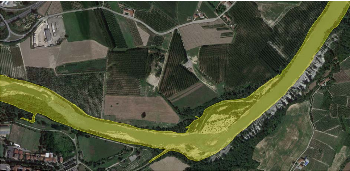
Figura i.3. Area di esondazione del F. Tanaro relativa alla situazione di progetto con sbarramento mobile completamente alzato e portata pari a 350 m 3 /s (portata massima contenuta all'interno dell'alveo inciso).
