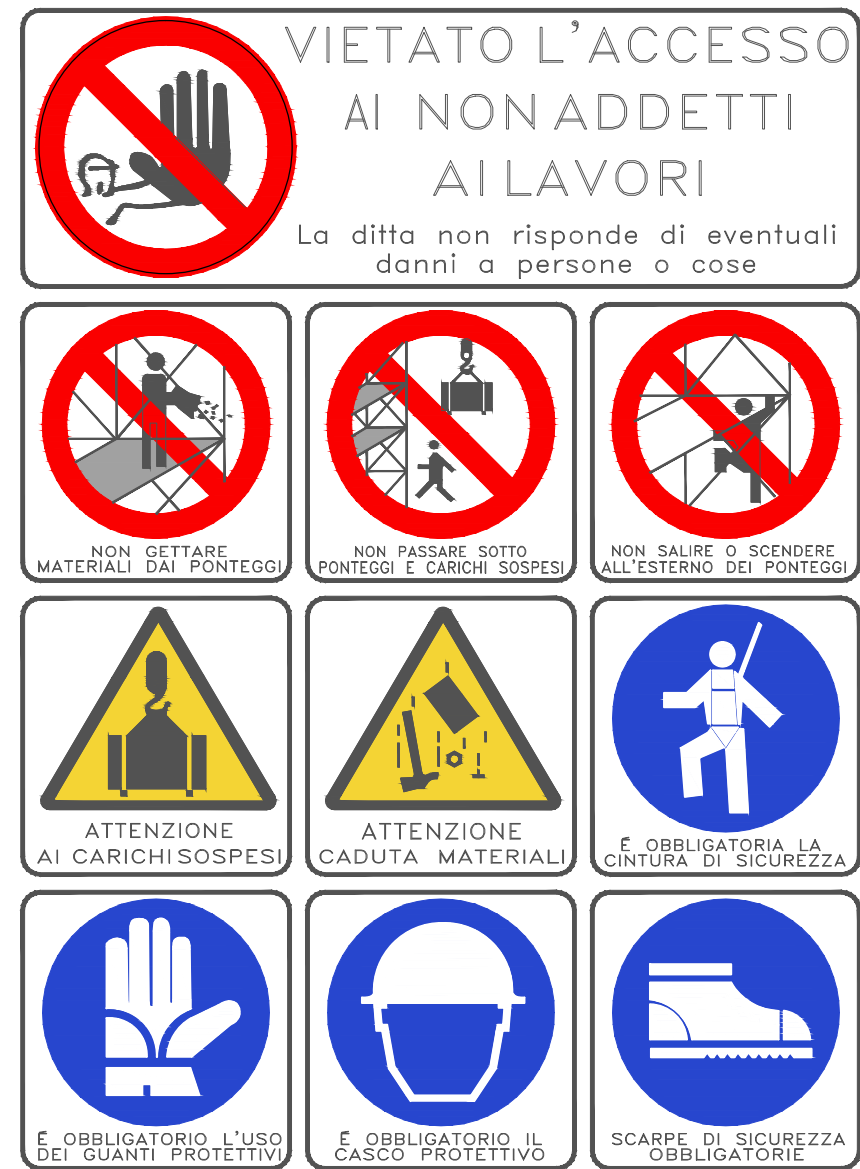
PARTICOLARE CARTELLONISTICA ACCESSO CANTIERE
