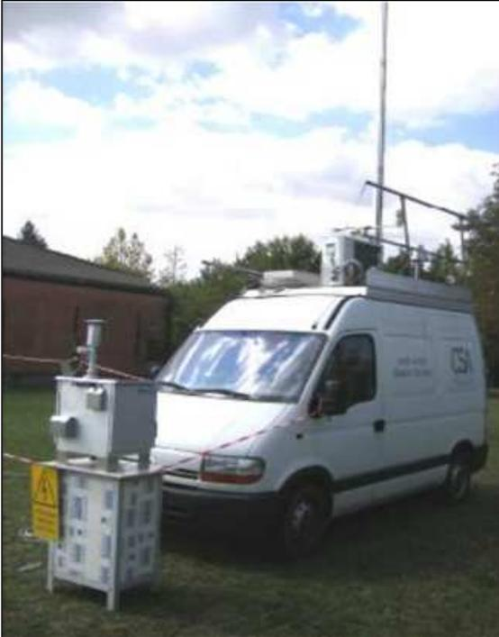
Figura 85: Mezzo mobile per il monitoraggio della qualità dell'aria
