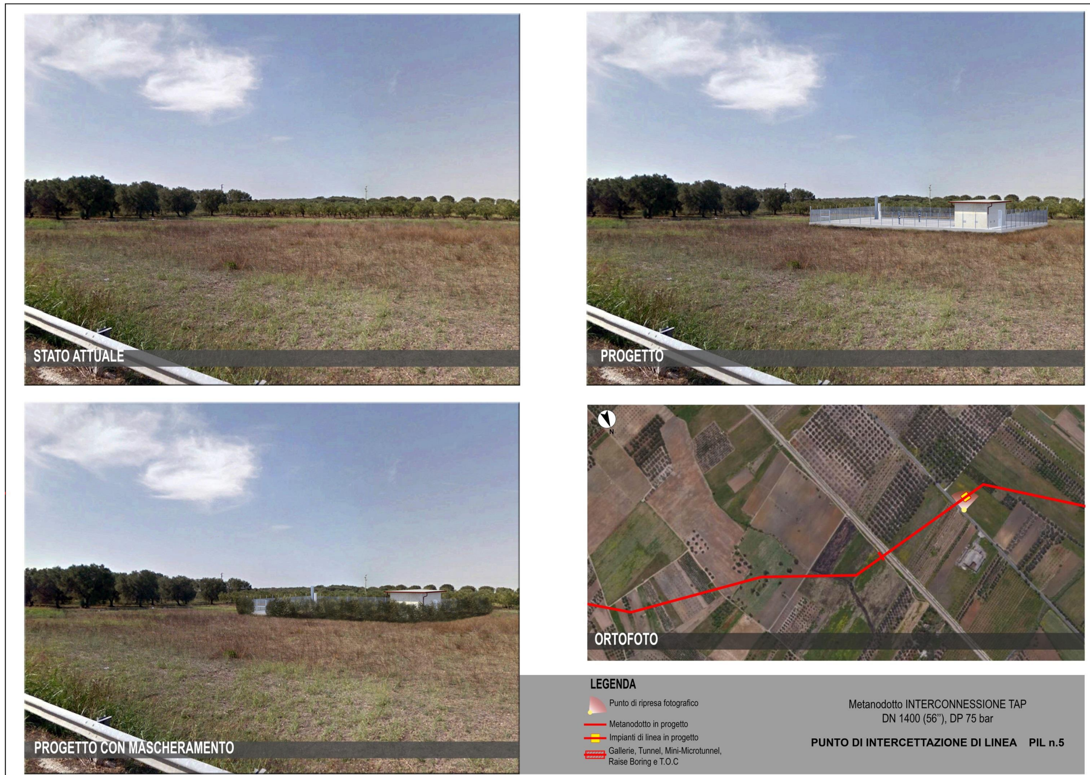
Fig 1/I - Met. Interconnessione TAP, DN 1400 (56"), DP 75 bar. Punto di intercettazione PIL n.5
