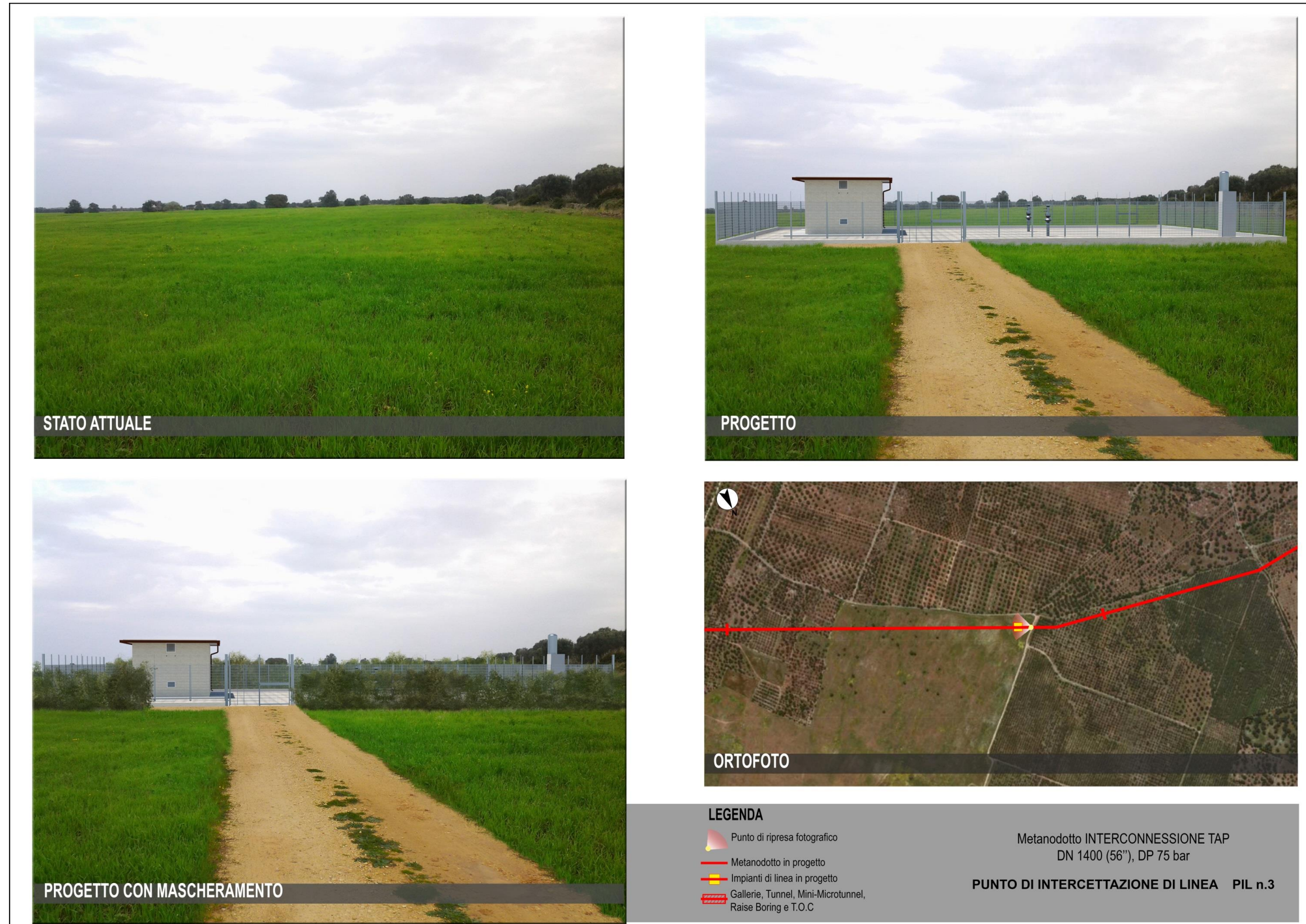
Fig 1/ G- Met. Interconnessione TAP, DN 1400 (56"), DP 75 bar. Punto di intercettazione PIL n.3
