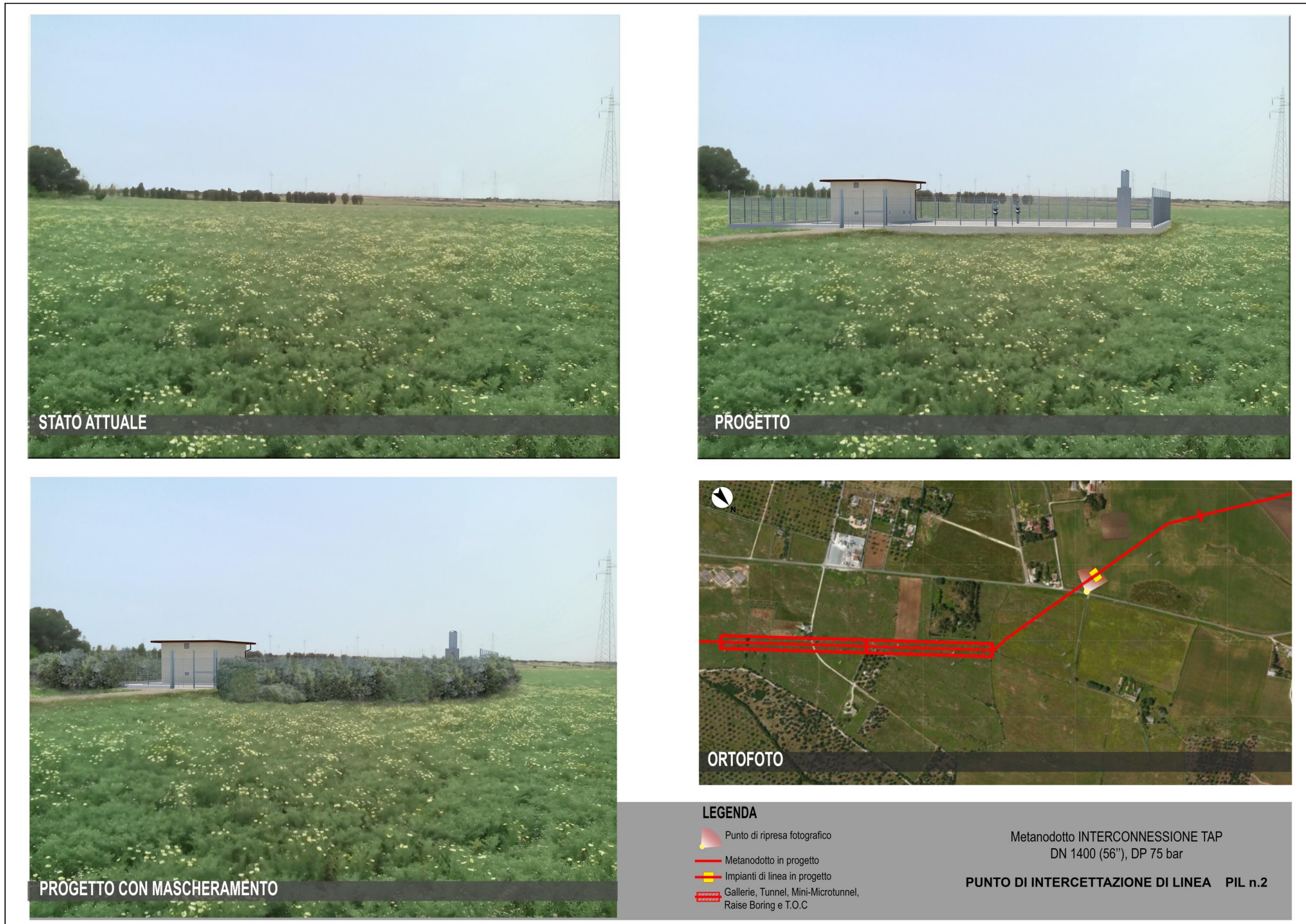
Fig 1/ F- Met. Interconnessione TAP, DN 1400 (56"), DP 75 bar. Punto di intercettazione PIL n.2
