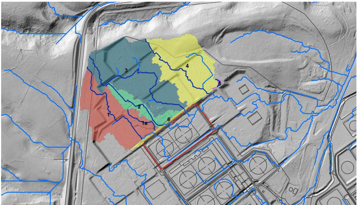
Figura 11 – Bacini idrografici a monte dell'area di progetto, percorsi idraulici più lunghi (blu) e rete di drenaggio superficiale (azzurro) calcolata sulla base del dtm con passo 1 m della Regione Sardegna (rilievo Lidar) su modello ombreggiato del terreno; area di progetto con contorno rosso
