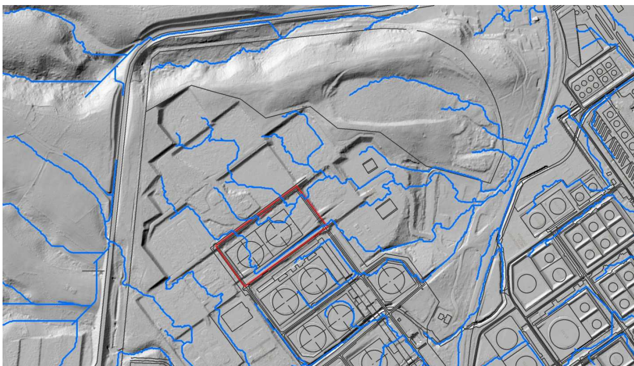
Figura 10 – Rete di drenaggio superficiale calcolata sulla base del dtm con passo 1 m della Regione Sardegna (rilievo Lidar), su modello ombreggiato del terreno; area di progetto con contorno rosso
