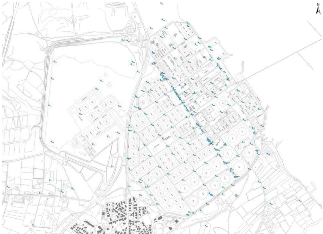
Figura 40 – Pozzi di monitoraggio della falda presso lo Stabilimento Sarlux - Impianti SUD di Sarroch
