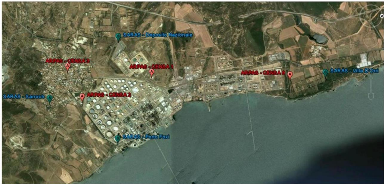
Figura 1 – Rete di monitoraggio della qualità dell'aria presso il sito produttivo di Sarroch
