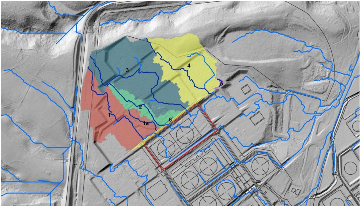
Figura 46 – Bacini idrografici a monte dell'area di progetto, percorsi idraulici più lunghi (blu) e rete di drenaggio superficiale (azzurro) calcolata sulla base del dtm con passo 1 m della Regione Sardegna (rilievo Lidar) su modello ombreggiato del terreno; area di progetto con contorno rosso
