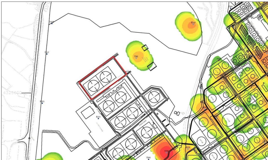
Figura 34 - Superamento CLA del Mn nella falda idrica superficiale; area di progetto con contorno rosso
