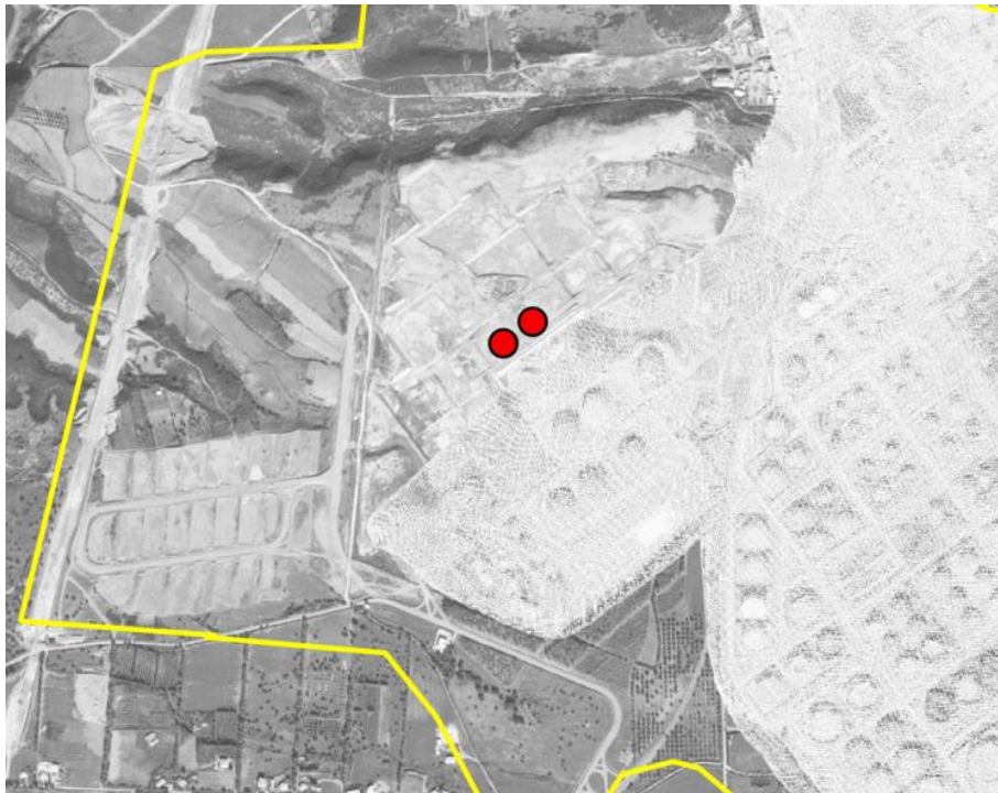
Figura 67 - Ubicazione dei nuovi serbatoi (in rosso) in sovrapposizione all'ortofoto 1988 che mostra come il progetto si sviluppi in un contesto già conformato per la realizzazione di tali opere. Sono evidenti i terrazzamenti già realizzati su cui sorgeranno i serbatoi.
