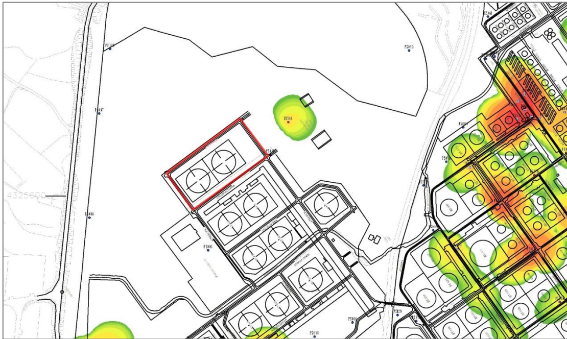
Figura 33 – Superamento CLA del Fe nella falda idrica superficiale; area di progetto con contorno rosso
