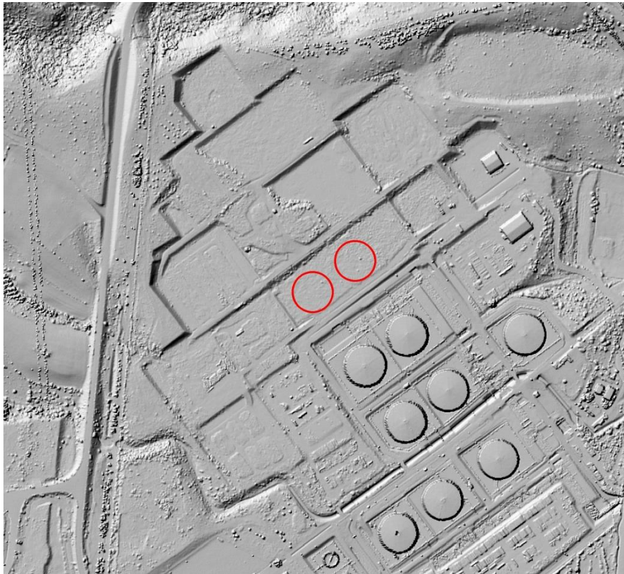
Figura 33 - Dettaglio estratto dal modello digitale delle superfici (fonte RAS) che mostra come l'ubicazione dei nuovi serbatoi (in rosso) avvenga in un contesto già conformato per la realizzazione di tali opere. Sono evidenti i terrazzamenti già realizzati su cui sorgeranno i serbatoi.
