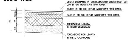
SEZIONE TIPO IN RILEVATO "CAT. A" AUTOSTRADALE IN CURVA - scala 1:100
