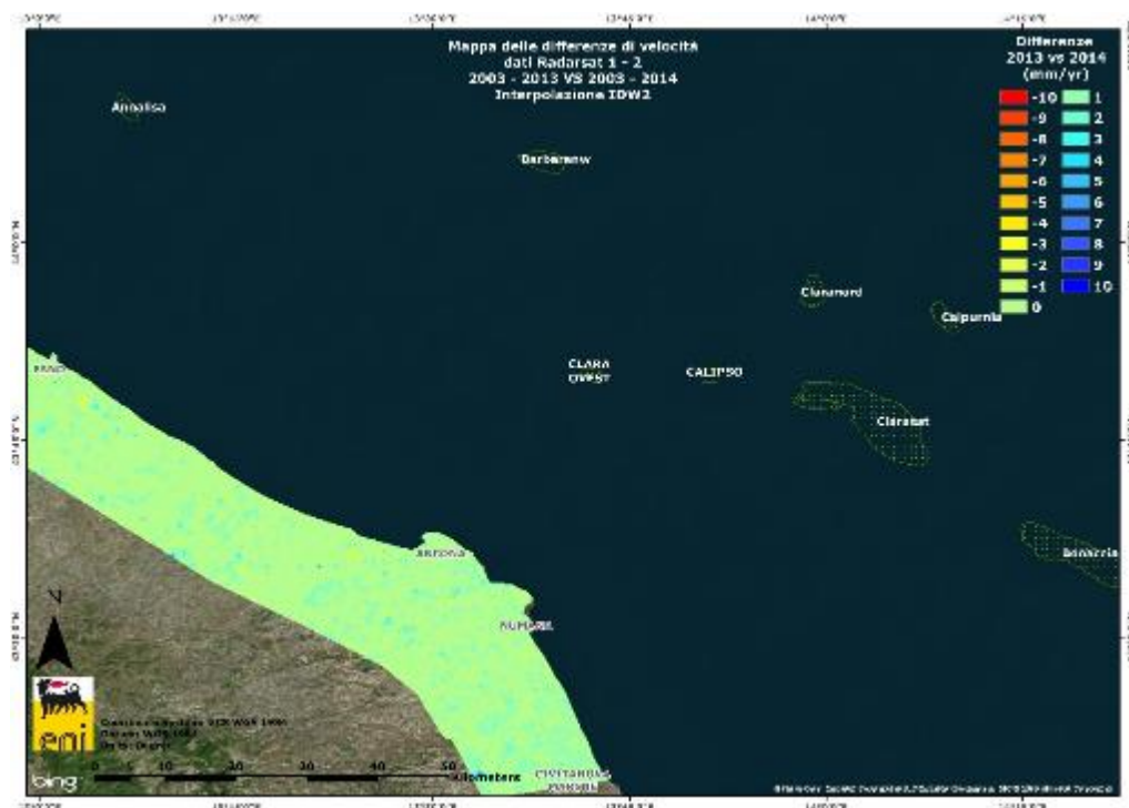
Fig. 5A – Tratto di costa da Fano a Porto Recanati: mappa delle differenze tra i database 2003-2013 e 2003-2014, utilizzando il Tool Math – Spatial Analyst di ArcGIS
