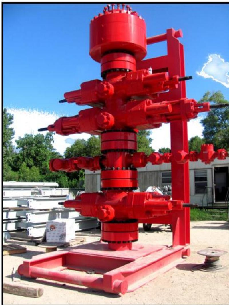
Il BOP è quindi un dispositivo di sicurezza, che viene utilizzato per contenere in pozzo la possibile risalita del fluido geotermico o del gas di strato in pressione.
