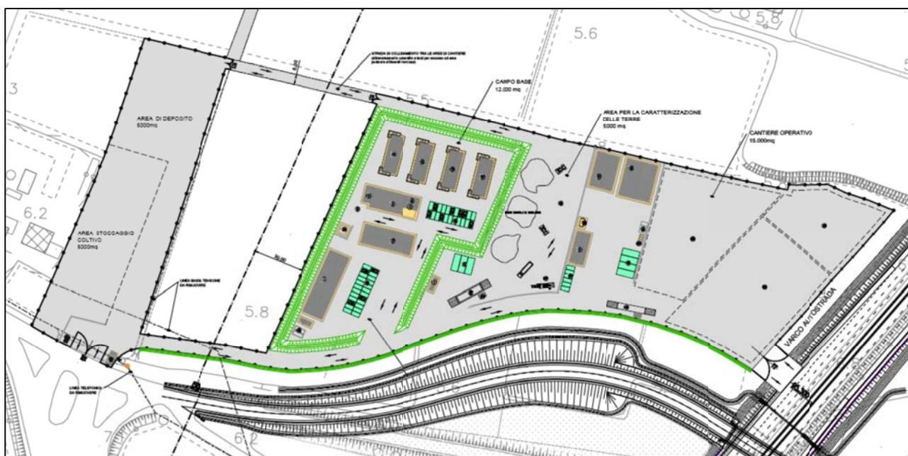
Figura 2-3 Layout dell'area di cantiere CB01
