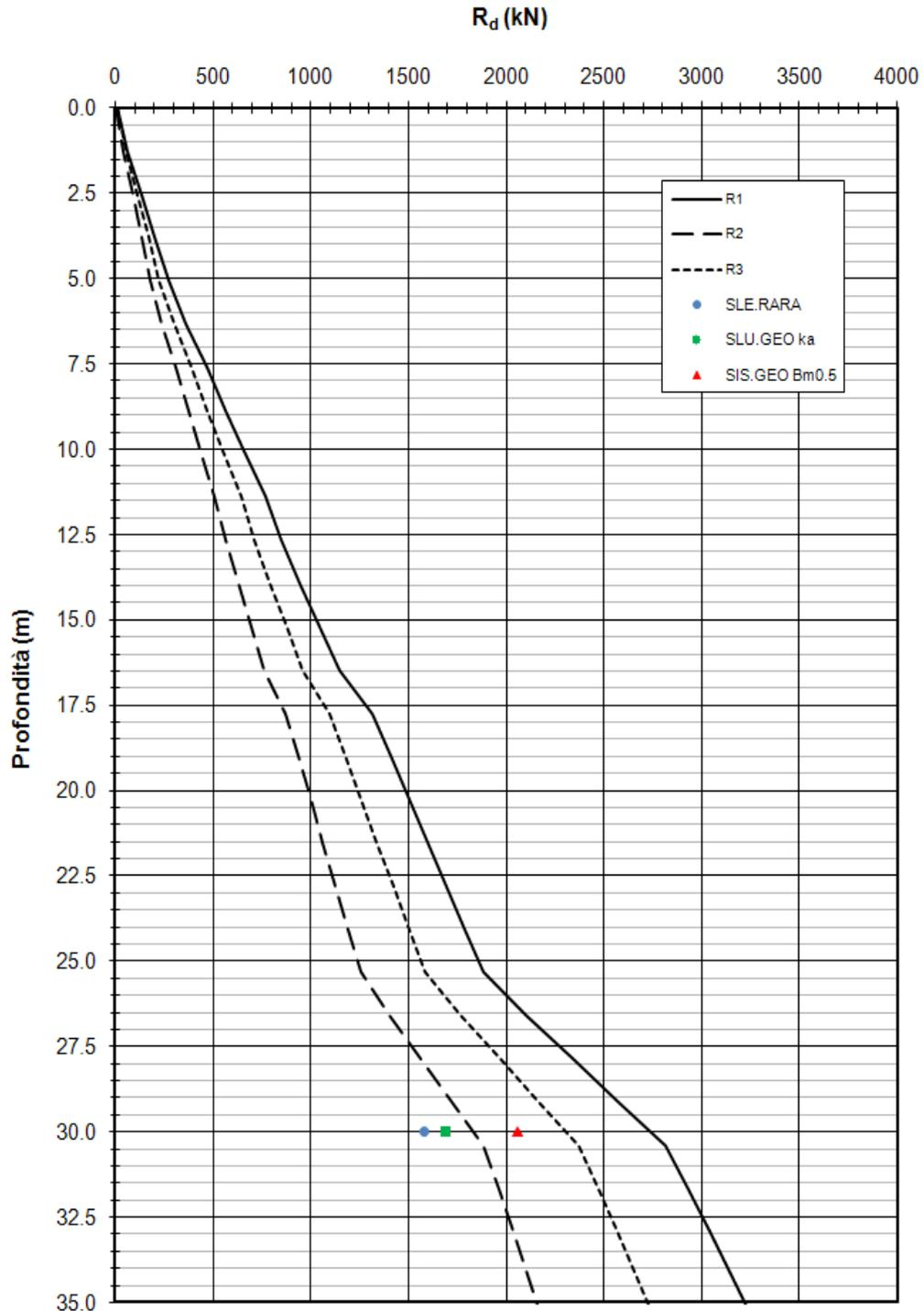
**Figura 10-14: Azioni assiali massime a confronto con le resistenze di progetto  $R_d$  per i pali trivellati soggetti a compressione**
