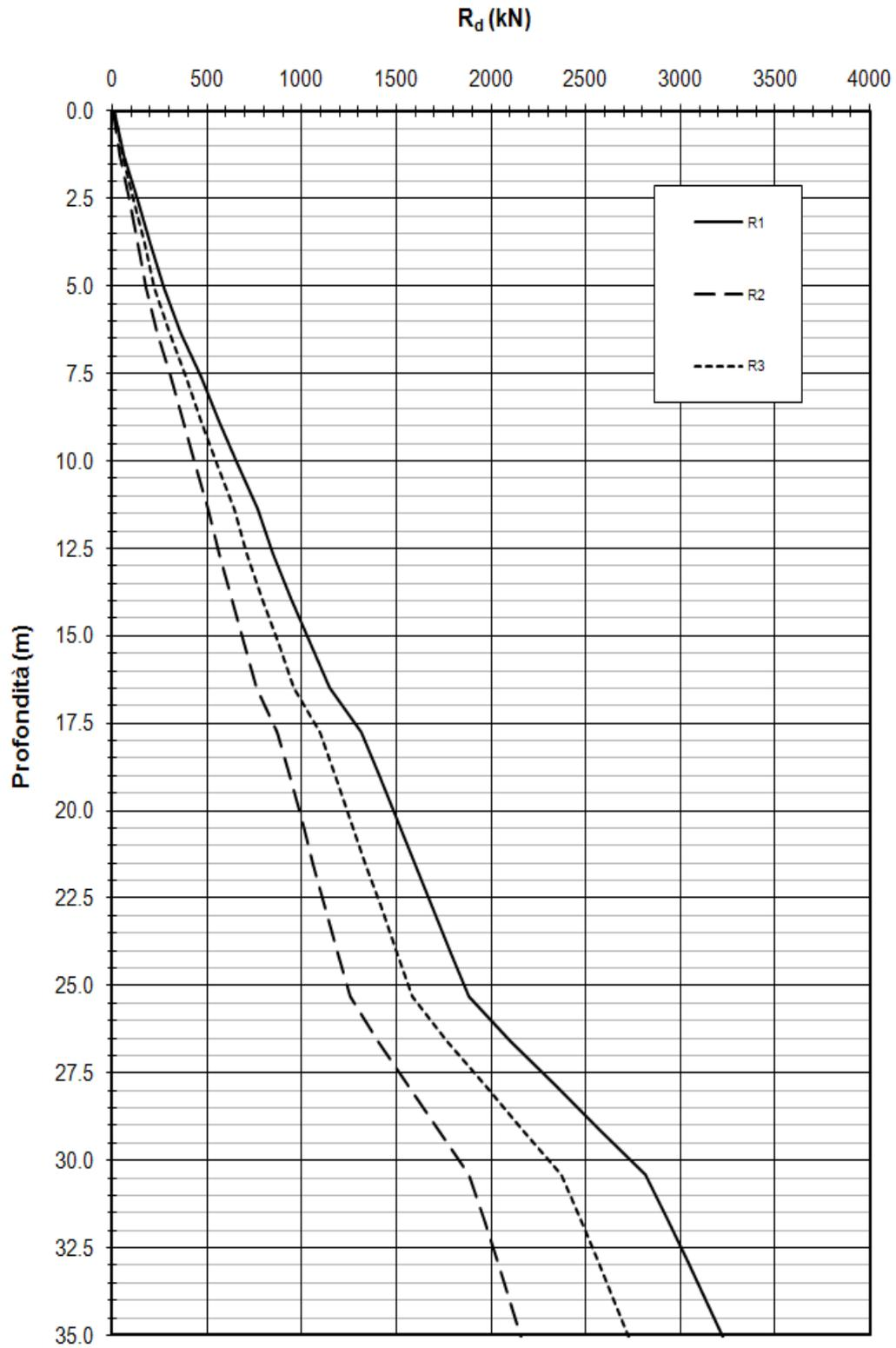
**Figura 10-5: Pali trivellati - Resistenza del palo a compressione**
