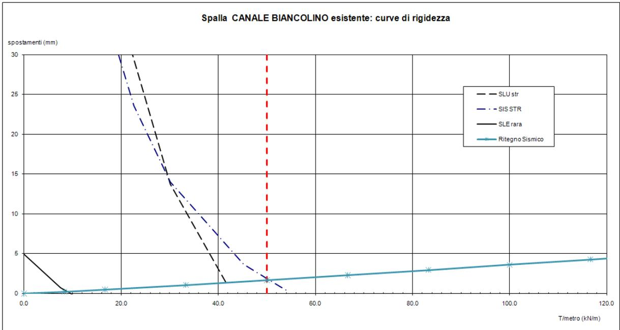
**Figura 6-1. Curva di interazione tra spalla e micropali passivi – comportamento fondazione spalla lineare**
