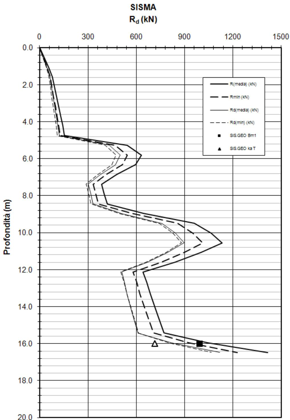
**Figura 10-11: Pali battuti - Azioni assiali massime a confronto con le resistenze di progetto  $R_d$  per i pali battuti soggetti a compressione – combinazione SIS**
