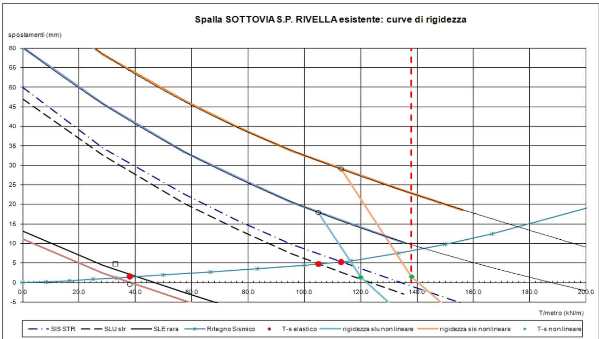
**Figura 10-7: Curva di Rigidezza Spalla Esistente – Ritegno Sismico**
