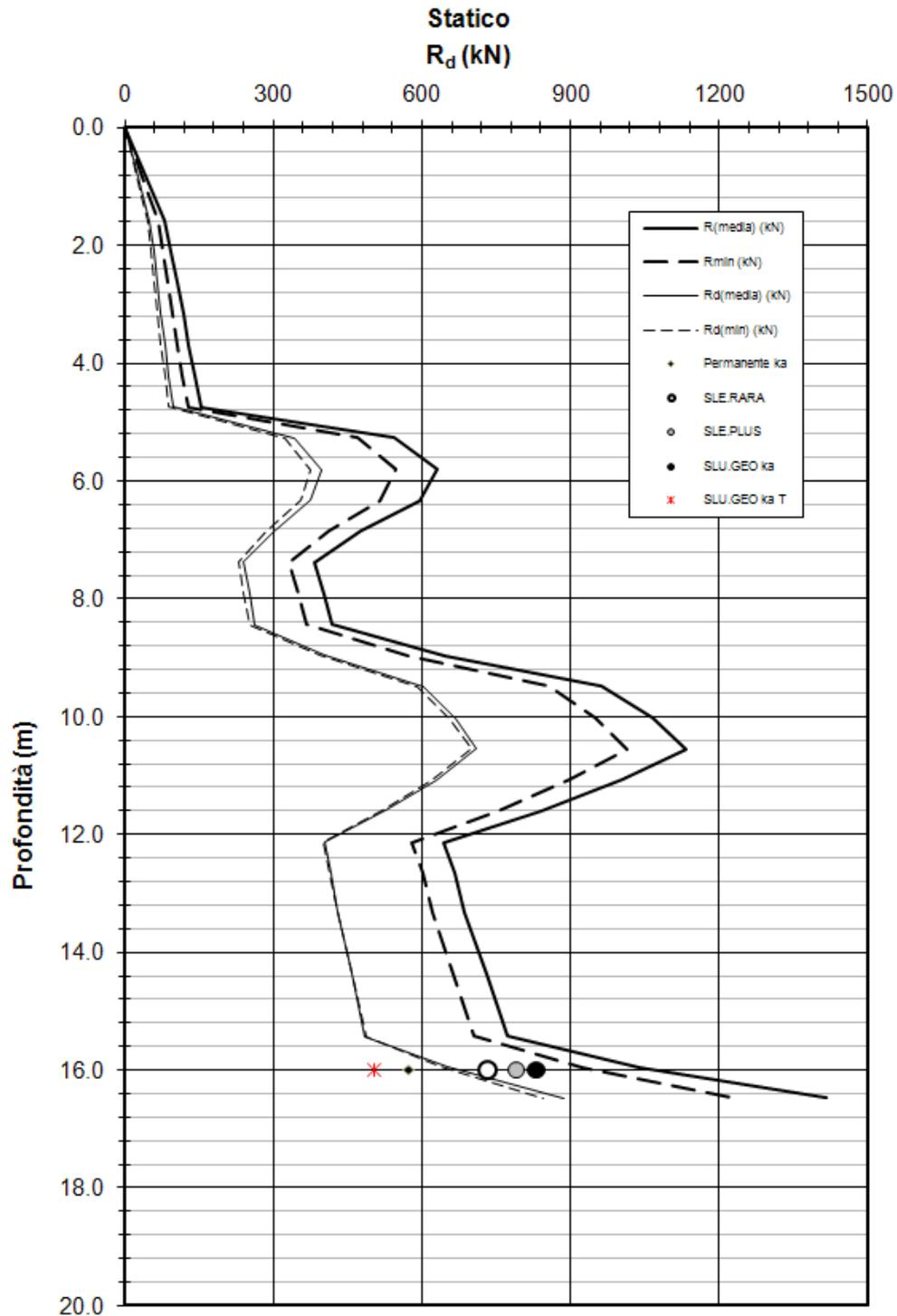
**Figura 10-10: Azioni assiali massime a confronto con le resistenze di progetto  $R_d$  per i pali battuti soggetti a compressione – combinazione SLU**
