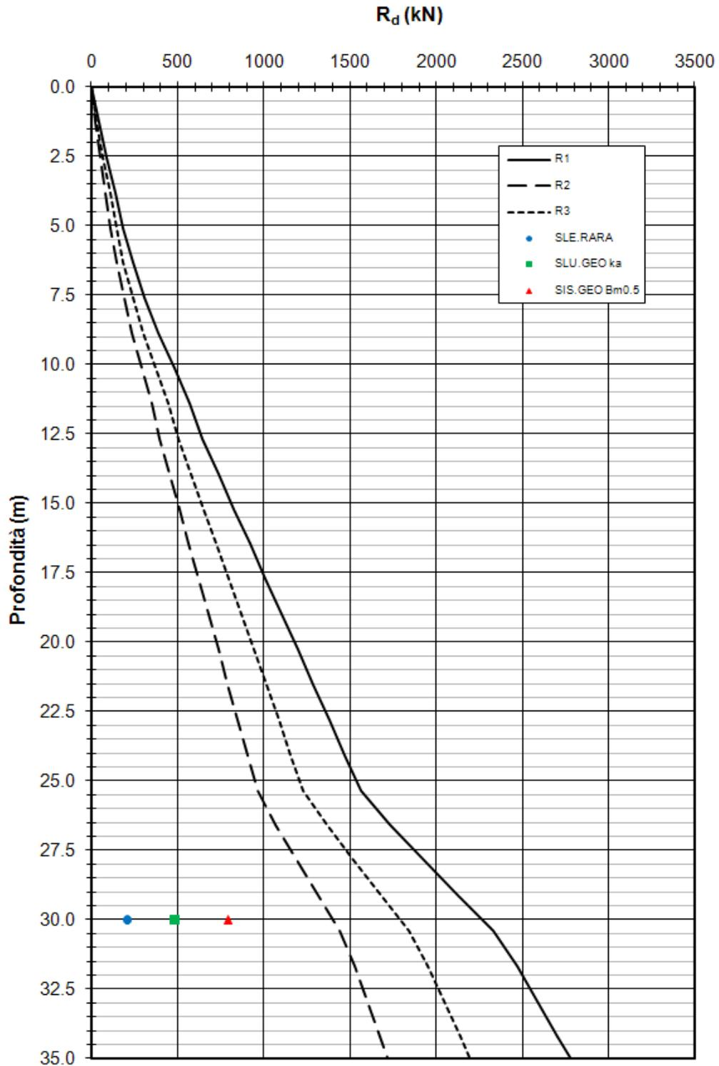
**Figura 10-15: Azioni assiali massime a confronto con le resistenze di progetto  $R_d$  per i pali trivellati soggetti a trazione – combinazione SLU-SIS**
