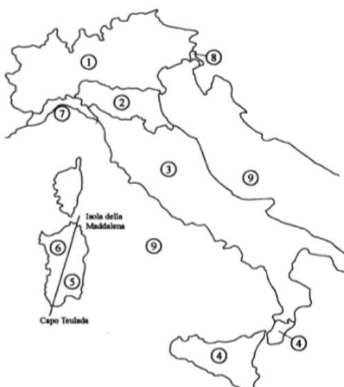
Figura 2: Definizione categorie di esposizione in funzione delle zone
