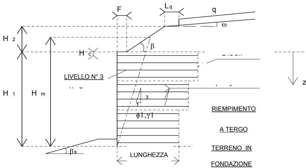
**Fig.1 - Sezione trasversale di un muro in terra armata (ad esempio sez. trapezoidale)**
