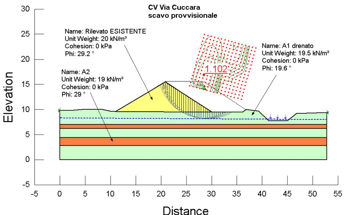
**Figura 1: Verifica di stabilità globale dello scavo provvisorio**
