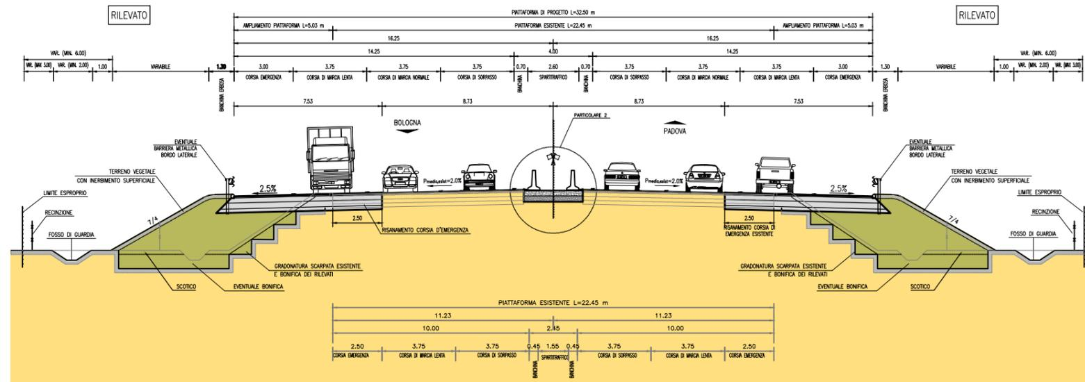
SEZIONE TIPO DI PROGETTO IN RETTIFILLO
