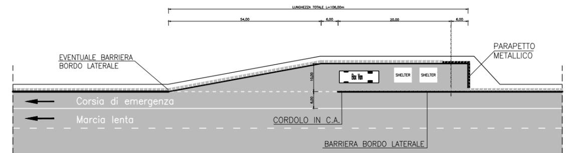
1/2 SEZIONE TIPO IN RETTIFILLO IN RILEVATO
