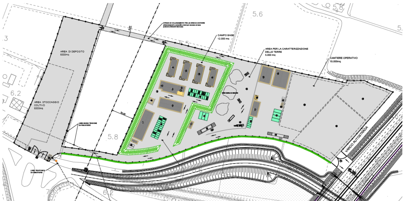
Figura 4: Layout aree di cantiere CB01
