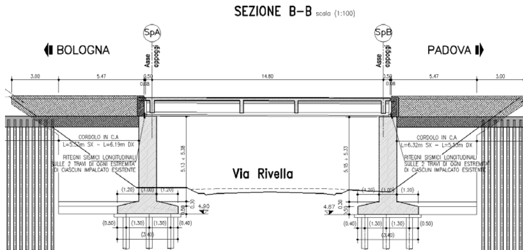
Profilo longitudinale impalcato esistente
