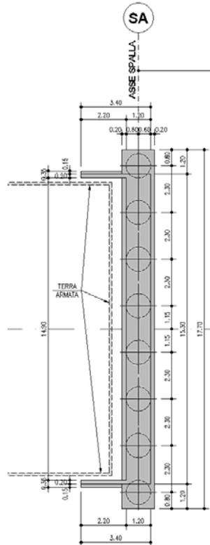
Sulla base delle verifiche geotecniche condotte (cfr. relazione geotecnica) tali pali si sviluppano per una profondità variabile riassunta in tabella.
