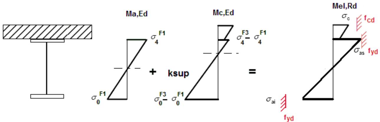
Quando la sezione è plasticizzata il coefficiente  $k$  risulta compreso fra 0 ed 1, e rappresenta il coefficiente moltiplicativo che riporta il diagramma di tensioni in fase 3 ad un diagramma al limite elastico.
