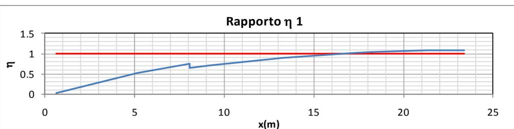
Nella sezione di estremità della zona plastica (prossimità sezione B\_S7), il valore della massima azione di compressione ( $N_A = N_C$  per simmetria) nella soletta nella combinazione allo S.L.U.  $M_{min}$  viene valutato con riferimento alle tensioni elastiche rilevate ai lembi della soletta ed in corrispondenza dell'armatura. Le tensioni vengono dedotte direttamente dall'output di pontiEC4 e sono richiamate in tabella.
