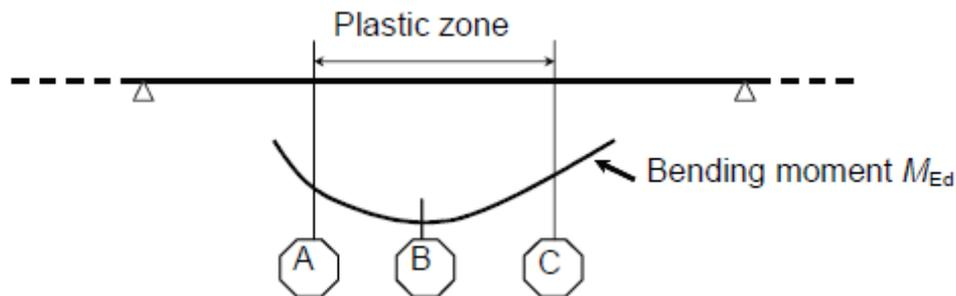
Il diagramma e la tabella seguente riportano l'andamento del massimo rapporto di sfruttamento elastico, valutato per la zona compresa tra l'incastro in spalla e la zona di mezzera trave ed evidenziano l'estensione della zona plastica.
