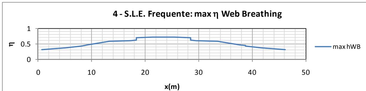
Come si può notare dall'esame del diagramma, la verifica di Web Breathing appare soddisfatta. La situazione più gravosa viene riscontrata in corrispondenza della sezione C\_S11, nella combinazione S.L.E. freq,  $V_{min}$ , con  $\eta_{WB} = 0.721 < 1.1$
