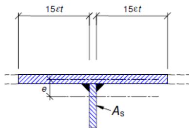
La verifica consiste nel confrontare l'inerzia dello stiffener  $I_{st}$  con quella limite, da valutarsi secondo quanto previsto in EN 1993-1-5 cap. 9.3.3.(3):
