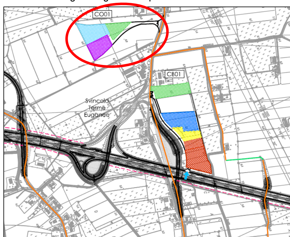
Figura 2-23 - Ubicazione area di cantiere CO01
