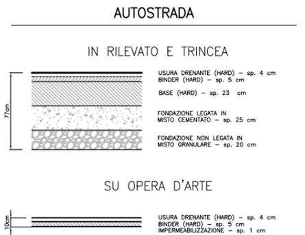
SEZIONE TIPO DI PROGETTO IN RETTIFILO
