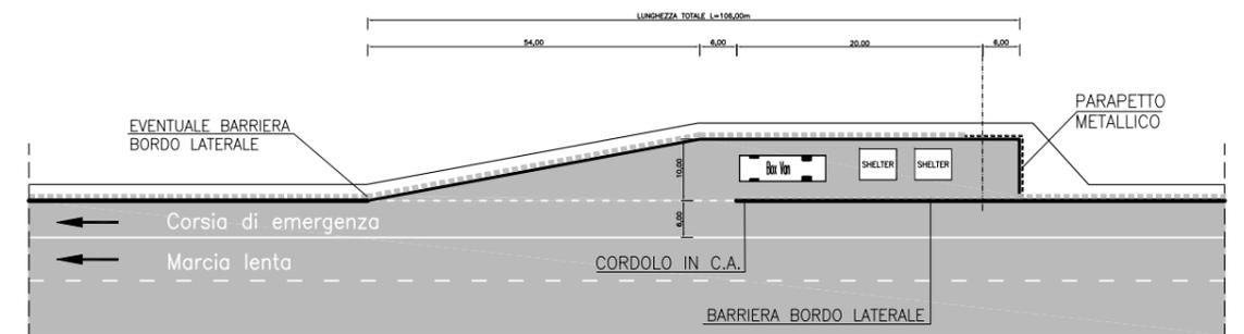
1/2 SEZIONE TIPO IN RETTIFILLO IN RILEVATO
