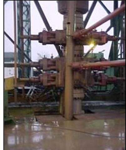
*Fig. 4.3.6.1.a – Particolare di una Testa Pozzo*
