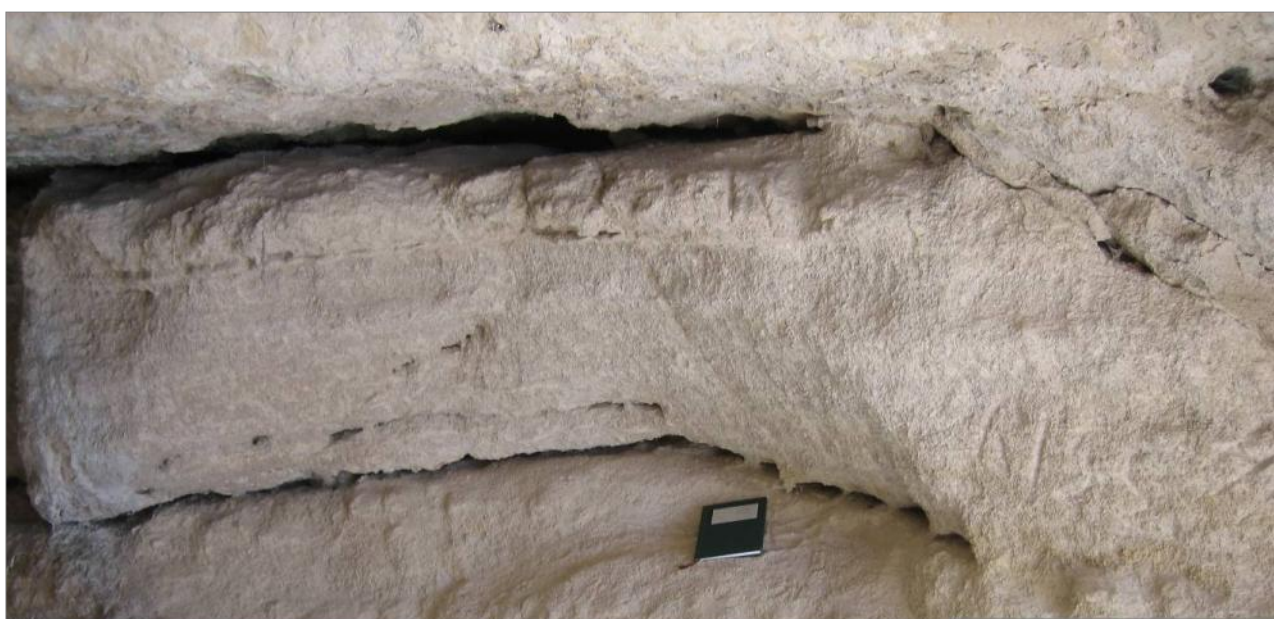
Figura 2.4 - Livello di calcareniti terziarie con alta porosità di matrice nei pressi di Matera
