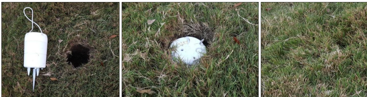
Figura 2.12 - Esempio di installazione di un geofono su sedimenti sciolti o terreno soffice. A sinistra: un foro di 15 cm di diametro viene scavato a una profondità di 25 cm. Al centro: il geofono viene posizionato in verticale e livellato col terreno. Il terreno asportato viene utilizzato per riempire lateralmente il foro intorno al geofono. A destra: il manto erboso viene ripristinato sulla parte superiore del geofono (fonte: Shell)
