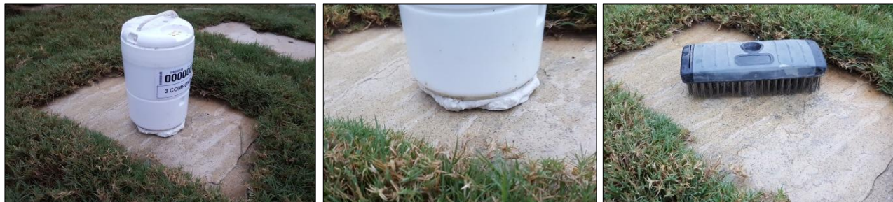
Figura 2.13 - Esempio di installazione di un geofono su roccia. A sinistra: geofono senza picchi fissato alla roccia con stucco/intonaco di Parigi. Al centro: primo piano della base del geofono. A destra: la rimozione dello stucco/intonaco-di-Parigi con acqua e spazzola restituisce la superficie alla sua condizione originale (fonte: Shell).
