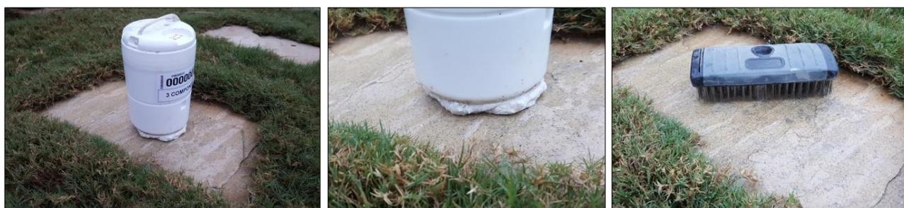
*Figura 3.13 - Esempio di installazione di un geofono su roccia. A sinistra: geofono senza picchi fissato alla roccia con stucco/intonaco di Parigi. Al centro: primo piano della base del geofono. A destra: la rimozione dello stucco/intonaco-di-Parigi con acqua e spazzola restituisce la superficie alla sua condizione originale (fonte: Shell).*
