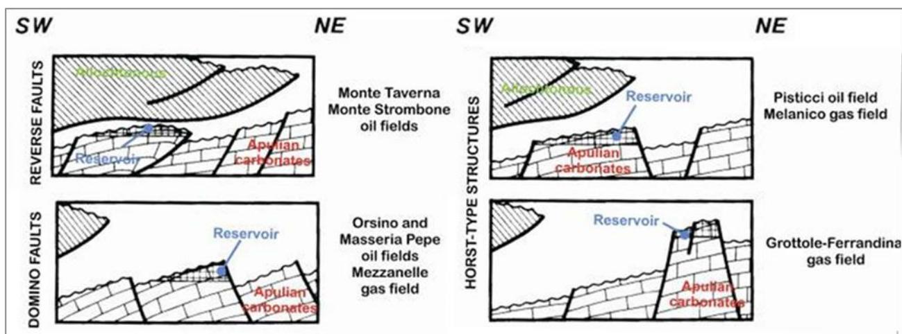
Figura 3.9 - Schemi delle varie tipologie di trappole (e relativi campi) impostesi nel substrato carbonatico pre-pliocenico e trappole in substrato plio-pleistocenico (fonte: Sella et al., 1988, modificato)
