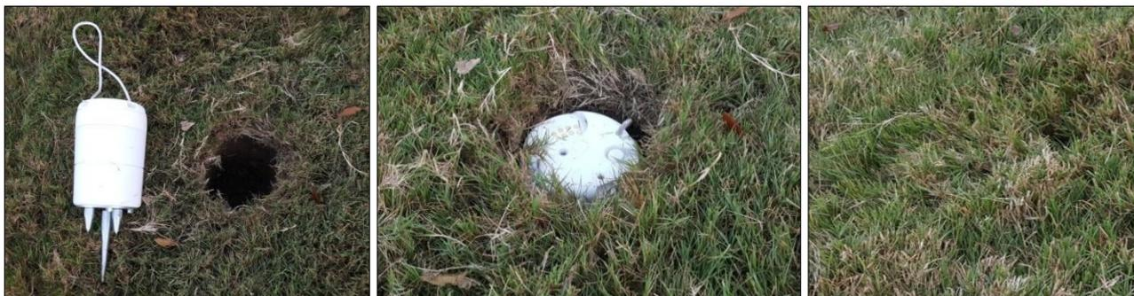
*Figura 3.12 - Esempio di installazione di un geofono su sedimenti sciolti o terreno soffice. A sinistra: un foro di 15 cm di diametro viene scavato a una profondità di 25 cm. Al centro: il geofono viene posizionato in verticale e livellato col terreno. Il terreno asportato viene utilizzato per riempire lateralmente il foro intorno al geofono. A destra: il manto erboso viene ripristinato sulla parte superiore del geofono (fonte: Shell)*
