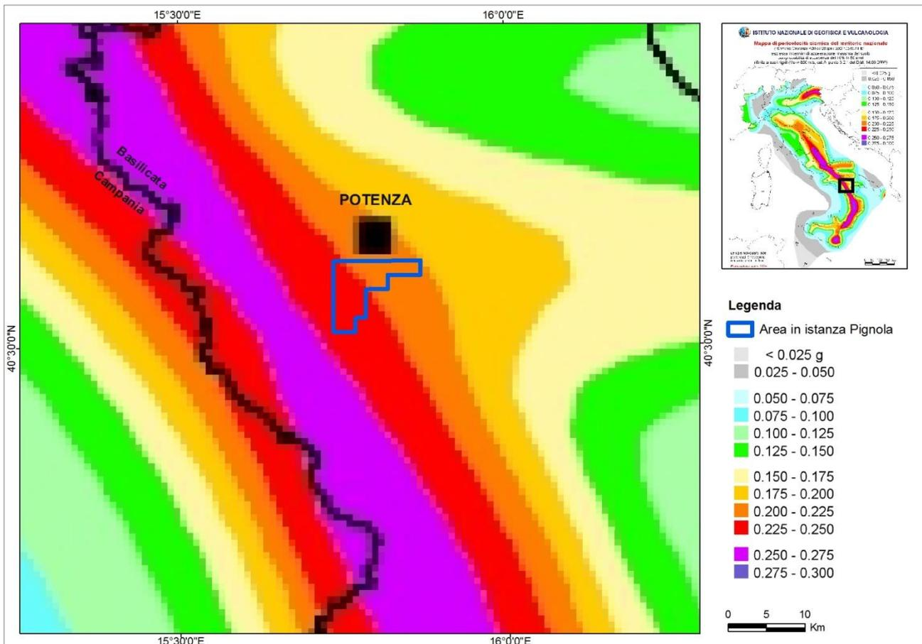
Figura 2.21 - Mappa di pericolosità sismica espressa in termini di accelerazione massima del suolo con probabilità di eccedenza del 10% in 50 anni riferita a suoli rigidi (fonte: [zonesismiche.mi.ingv.it/mappa\\_ps\\_apr04/italia.html](http://zonesismiche.mi.ingv.it/mappa_ps_apr04/italia.html), modificata)
