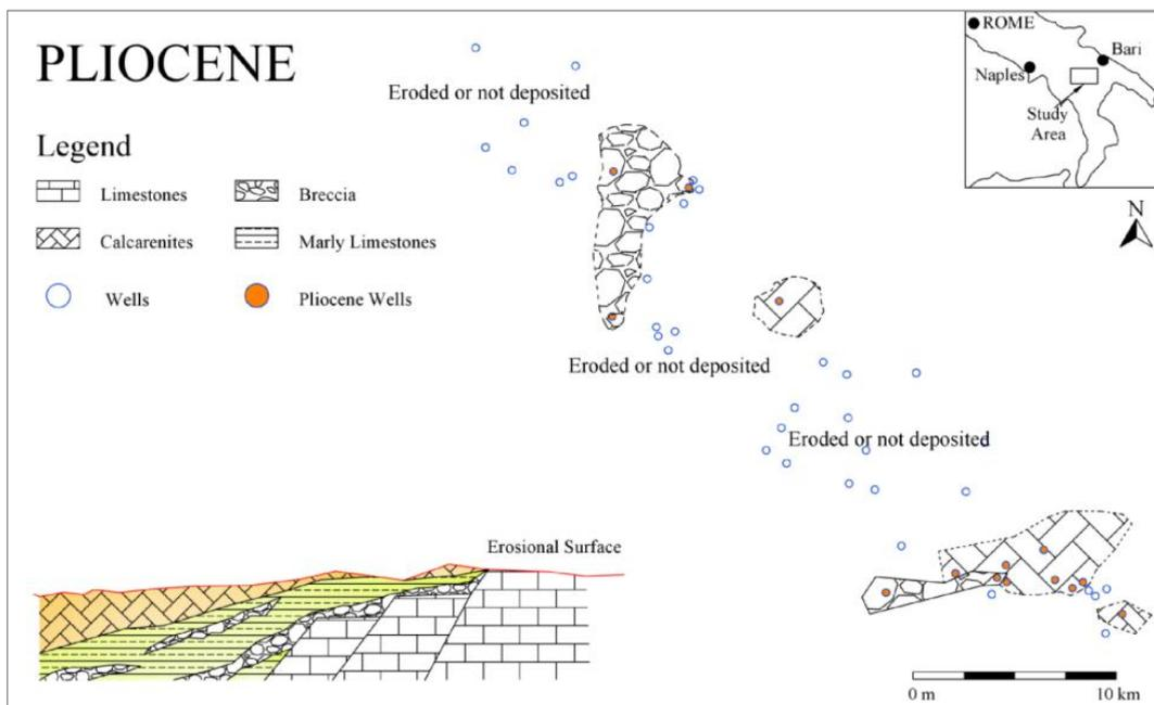
Figura 4.13 - Nel Pliocene le zone più depresse appaiono quasi completamente riempite da materiale tipico di margine di piattaforma, testimoniato anche dalla presenza di una superficie erosiva dovuta ad emersione della stessa
