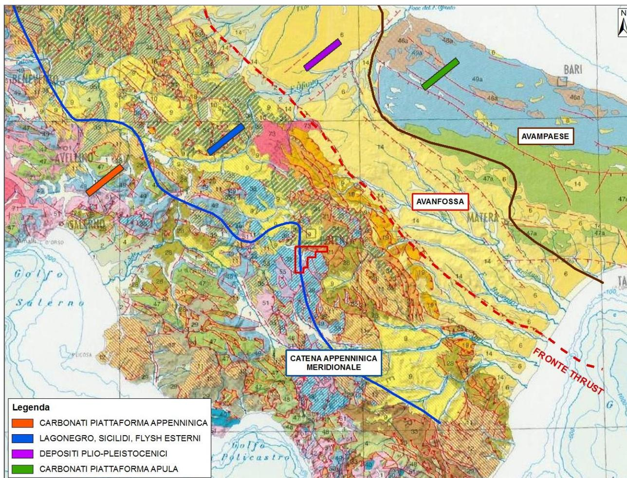
Figura 4.7 - Mappa delle principali unità geologico-strutturali dell'Appennino Meridionale e ubicazione del blocco in studio su Carta geologica d'Italia scala 1:1.000.000 (Servizio Geologico d'Italia - Ispra, 2011 modificata)
