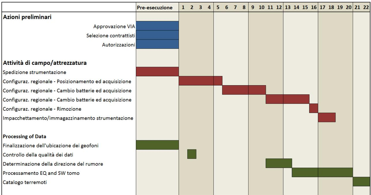
Figura 3.11 - Programma cronologico preliminare relativo all'esecuzione della campagna di acquisizione sismica passiva, in rosso, ed all'analisi dei dati ottenuti, in verde (fonte: Shell)
