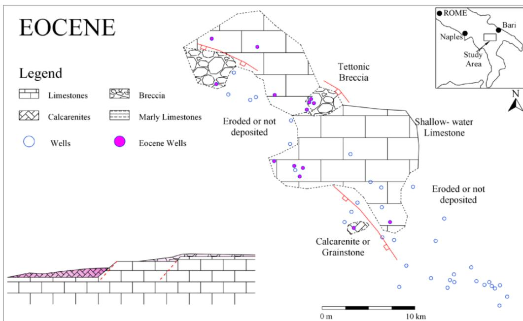
Figura 4.11 - Assetto durante l'Eocene del settore in studio; i calcari iniziano a subire le prime deformazioni con fagliazione a cinematica diretta e deposizione dei primi sedimenti calcarenitici e breccie (vedi sezione interpretativa)
