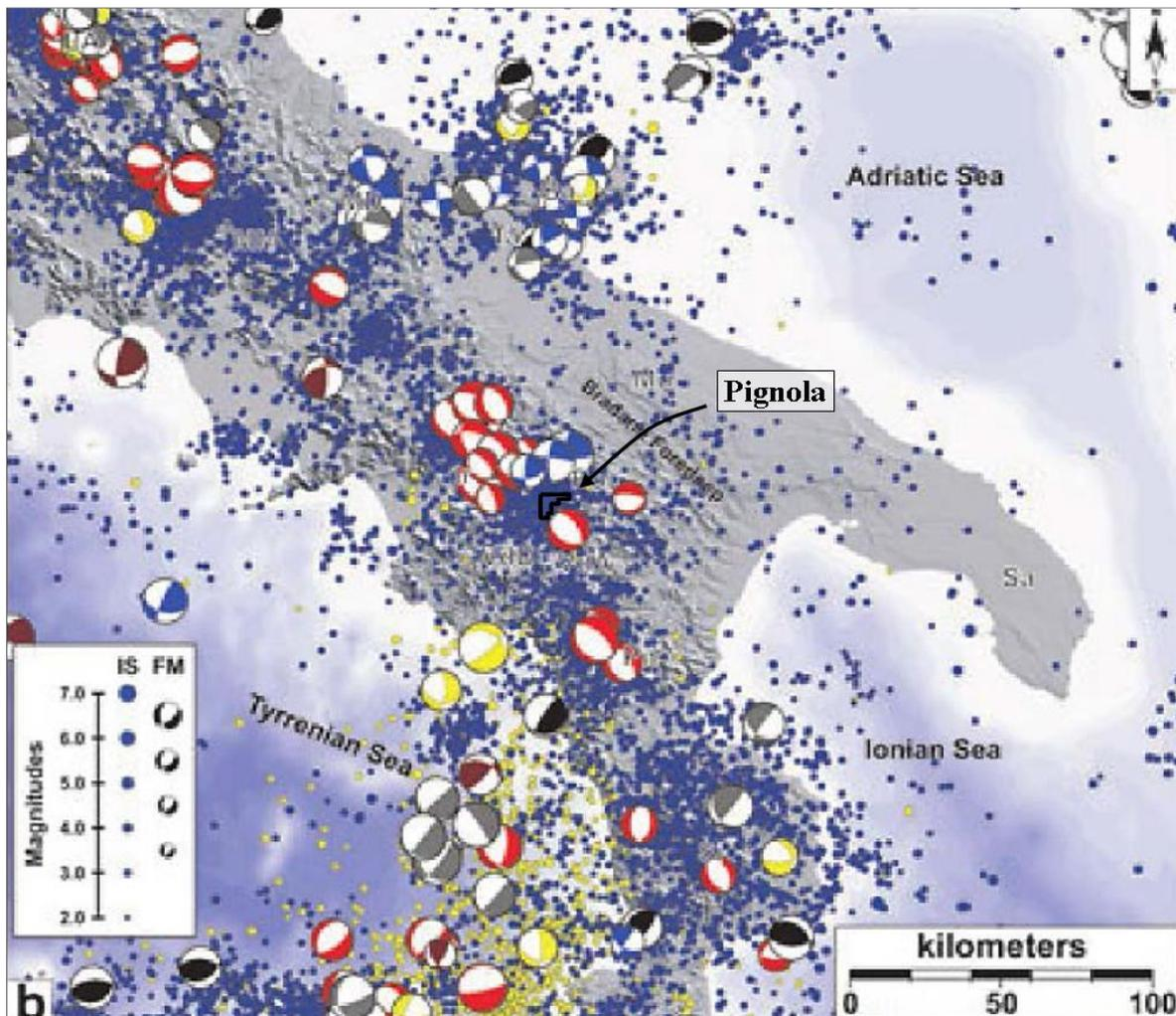
Figura 4.17 - Sismicità strumentale (IS) con magnitudo  $\geq 2$  dal 1983. Blu per eventi avvenuti a profondità  $< 30$  km; giallo per eventi avvenuti a profondità  $> 30$  km. È inoltre riportato, tramite i palloni da spiaggia, il meccanismo focale (FM) degli eventi con magnitudo  $> 3.5$  (fonte: Palano et al., 2011, modificata).
