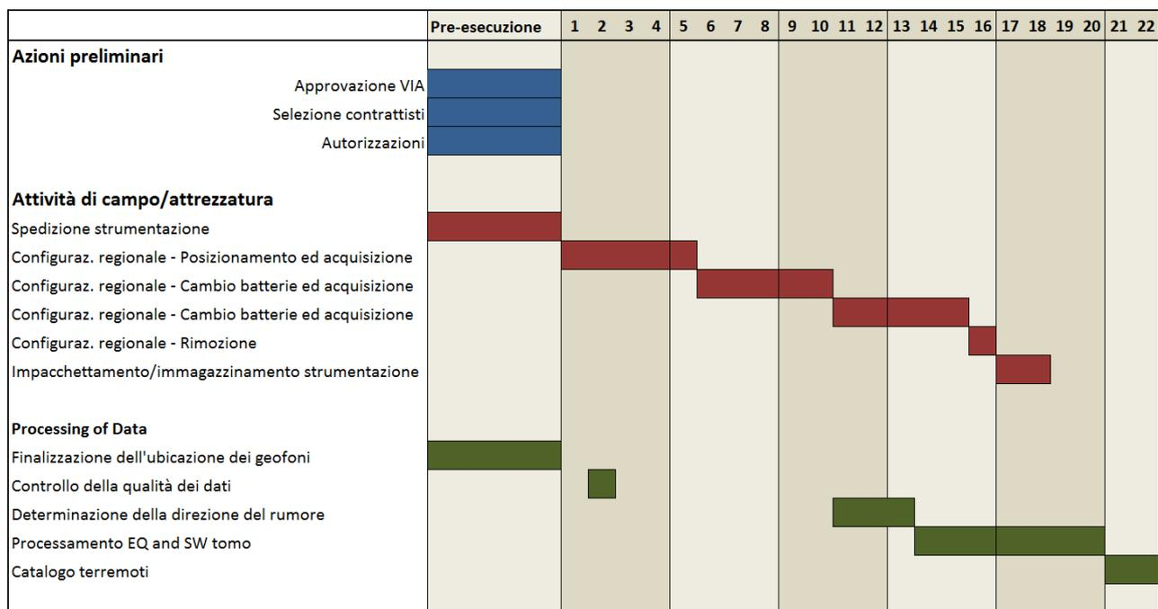
Figura 3.3 - Programma cronologico preliminare relativo all'esecuzione della campagna di acquisizione sismica passiva, in rosso, ed all'analisi dei dati ottenuti, in verde (fonte: Shell)
