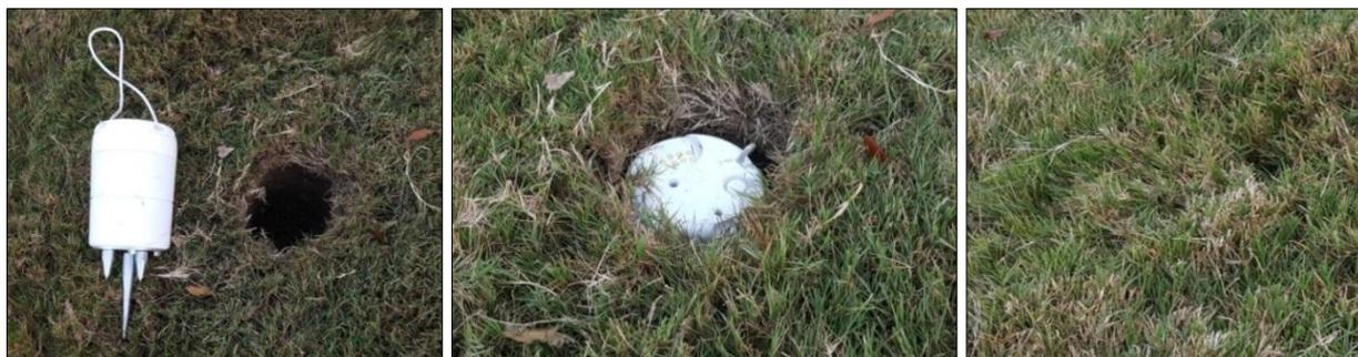
Figura 3.4 - Esempio di installazione di un geofono su sedimenti sciolti o terreno soffice. A sinistra: un foro di 15 cm di diametro viene scavato a una profondità di 25 cm. Al centro: il geofono viene posizionato in verticale e livellato col terreno. Il terreno asportato viene utilizzato per riempire lateralmente il foro intorno al geofono. A destra: il manto erboso viene ripristinato sulla parte superiore del geofono (fonte: Shell)
