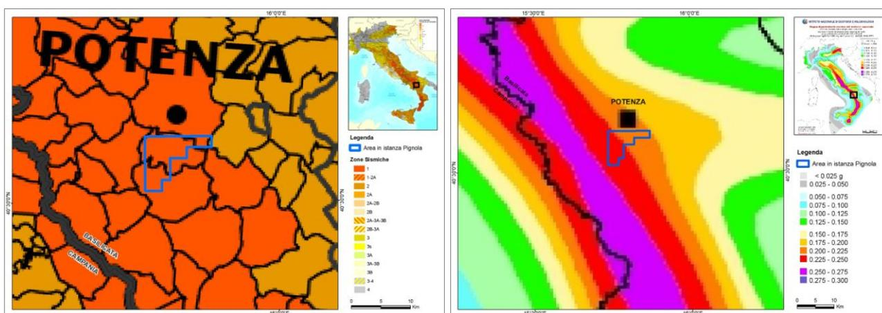
Figura 2.12 - Mappa di pericolosità sismica espressa in termini di accelerazione massima del suolo con probabilità di eccedenza del 10% in 50 anni riferita a suoli rigidi (fonte: [zonesismiche.mi.ingv.it/mappa\\_ps\\_apr04/italia.html](http://zonesismiche.mi.ingv.it/mappa_ps_apr04/italia.html), modificata)
