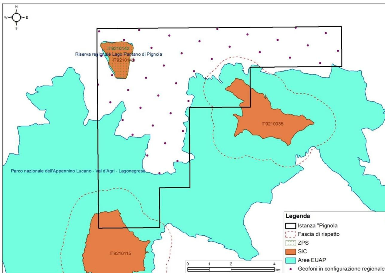
Figura 3.2 - Ubicazione dei geofoni all'interno dell'area in istanza di permesso di ricerca “Pignola”, in configurazione regionale (fonte dei dati: Shell)
