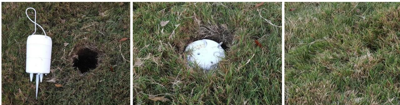
Figura 2.16 - Esempio di installazione di un geofono su sedimenti sciolti o terreno soffice. A sinistra: un foro di 15 cm di diametro viene scavato a una profondità di 25 cm. Al centro: il geofono viene posizionato in verticale e livellato col terreno. Il terreno asportato viene utilizzato per riempire lateralmente il foro intorno al geofono. A destra: il manto erboso viene ripristinato sulla parte superiore del geofono (fonte: Shell)
