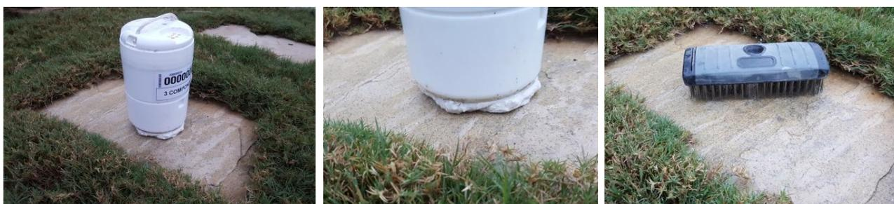
Figura 2.17 - Esempio di installazione di un geofono su roccia. A sinistra: geofono senza picchi fissato alla roccia con stucco/intonaco di Parigi. Al centro: primo piano della base del geofono. A destra: la rimozione dello stucco/intonaco-di-Parigi con acqua e spazzola restituisce la superficie alla sua condizione originale (fonte: Shell)
