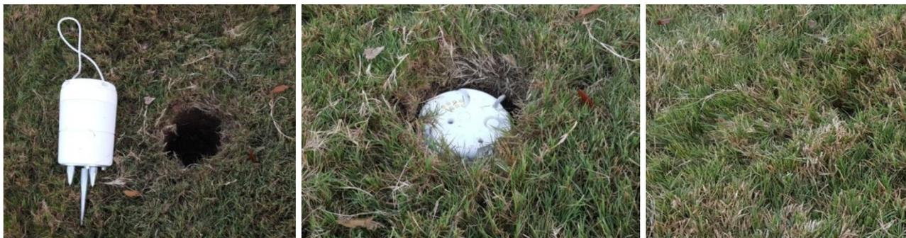
Figura 3.16 - Esempio di installazione di un geofono su sedimenti sciolti o terreno soffice. A sinistra: un foro di 15 cm di diametro viene scavato a una profondità di 25 cm. Al centro: il geofono viene posizionato in verticale e livellato col terreno. Il terreno asportato viene utilizzato per riempire lateralmente il foro intorno al geofono. A destra: il manto erboso viene ripristinato sulla parte superiore del geofono (fonte: Shell)
