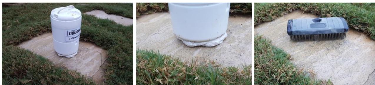
Figura 3.17 - Esempio di installazione di un geofono su roccia. A sinistra: geofono senza picchi fissato alla roccia con stucco/intonaco di Parigi. Al centro: primo piano della base del geofono. A destra: la rimozione dello stucco/intonaco-di-Parigi con acqua e spazzola restituisce la superficie alla sua condizione originale (fonte: Shell)
