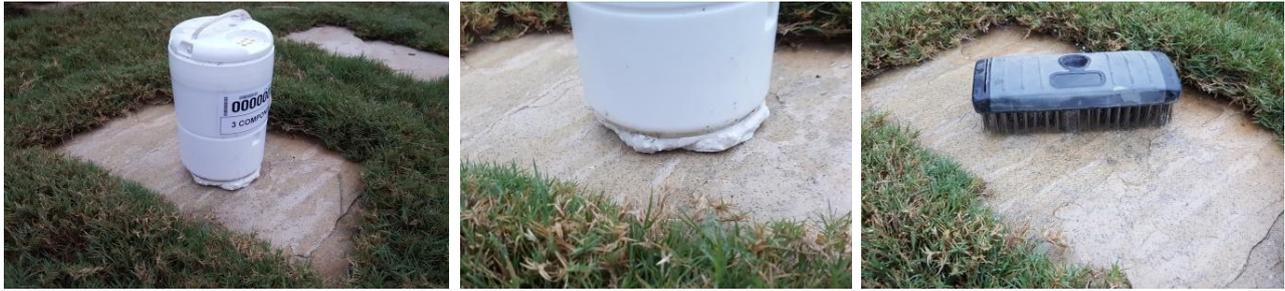
*Figura 3.5 - Esempio di installazione di un geofono su roccia. A sinistra: geofono senza picchi fissato alla roccia con stucco/intonaco di Parigi. Al centro: primo piano della base del geofono. A destra: la rimozione dello stucco/intonaco-di-Parigi con acqua e spazzola restituisce la superficie alla sua condizione originale (fonte: Shell)*
