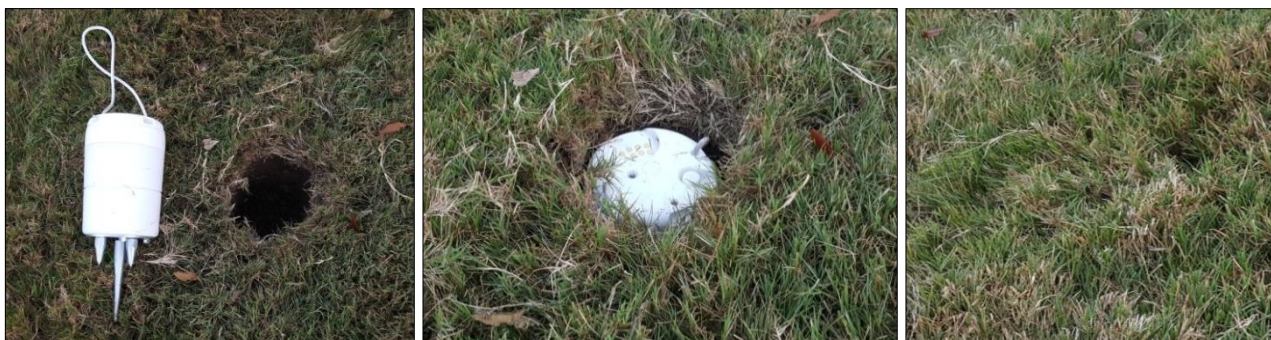
Figura 2.13 - Esempio di installazione di un geofono su sedimenti sciolti o terreno soffice. A sinistra: un foro di 15 cm di diametro viene scavato a una profondità di 25 cm. Al centro: il geofono viene posizionato in verticale e livellato col terreno. Il terreno asportato viene utilizzato per riempire lateralmente il foro intorno al geofono. A destra: il manto erboso viene ripristinato sulla parte superiore del geofono (fonte: Shell)
