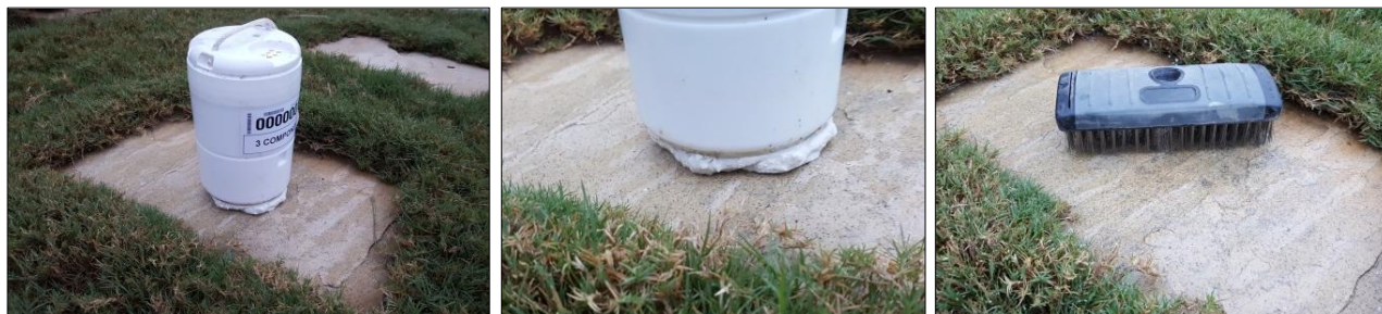
Figura 2.14 - Esempio di installazione di un geofono su roccia. A sinistra: geofono senza picchi fissato alla roccia con stucco/intonaco di Parigi. Al centro: primo piano della base del geofono. A destra: la rimozione dello stucco/intonaco-di-Parigi con acqua e spazzola restituisce la superficie alla sua condizione originale (fonte: Shell).
