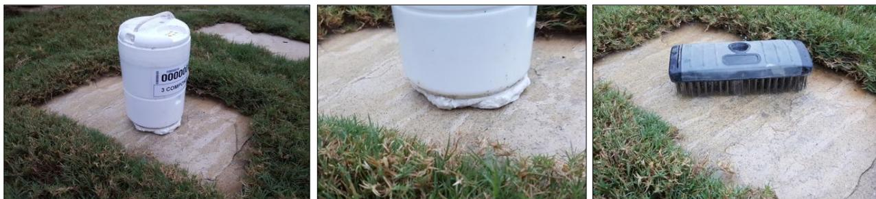
*Figura 3.14 - Esempio di installazione di un geofono su roccia. A sinistra: geofono senza picchi fissato alla roccia con stucco/intonaco di Parigi. Al centro: primo piano della base del geofono. A destra: la rimozione dello stucco/intonaco-di-Parigi con acqua e spazzola restituisce la superficie alla sua condizione originale (fonte: Shell).*
