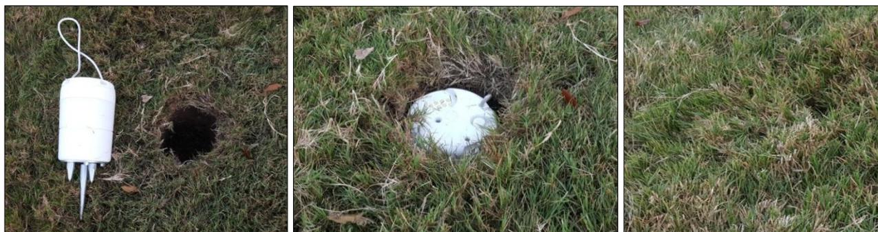
*Figura 3.13 - Esempio di installazione di un geofono su sedimenti sciolti o terreno soffice. A sinistra: un foro di 15 cm di diametro viene scavato a una profondità di 25 cm. Al centro: il geofono viene posizionato in verticale e livellato col terreno. Il terreno asportato viene utilizzato per riempire lateralmente il foro intorno al geofono. A destra: il manto erboso viene ripristinato sulla parte superiore del geofono (fonte: Shell)*
