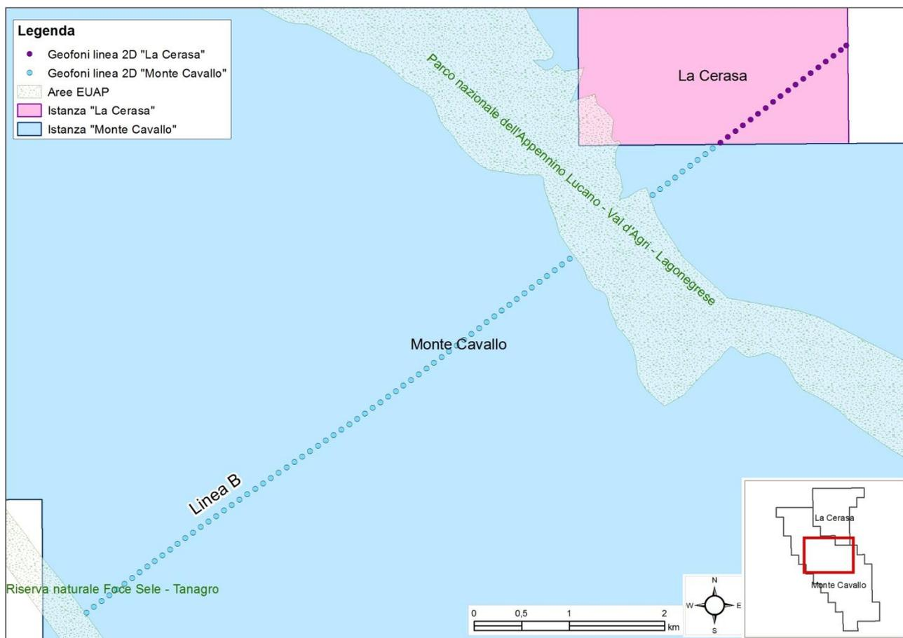
Figura 5.1 – Linea 2D (denominata “Linea B”) acquisita nel passato che interessa le due istanze di permesso di ricerca “La Cerasa” e “Monte Cavallo”. Tale linea è utilizzata come traccia per lo stendimento dei geofoni per l’acquisizione sismica di dettaglio (fonte dei dati: Shell).
