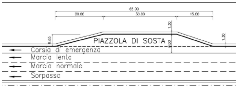
Figura 2-3 Piazzole di sosta in rilevato/trincea
