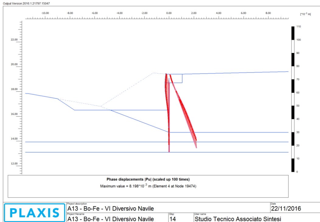
Figura 10. Spostamenti totali allo SLE dei micropali |u_{max}| = 8 mm
