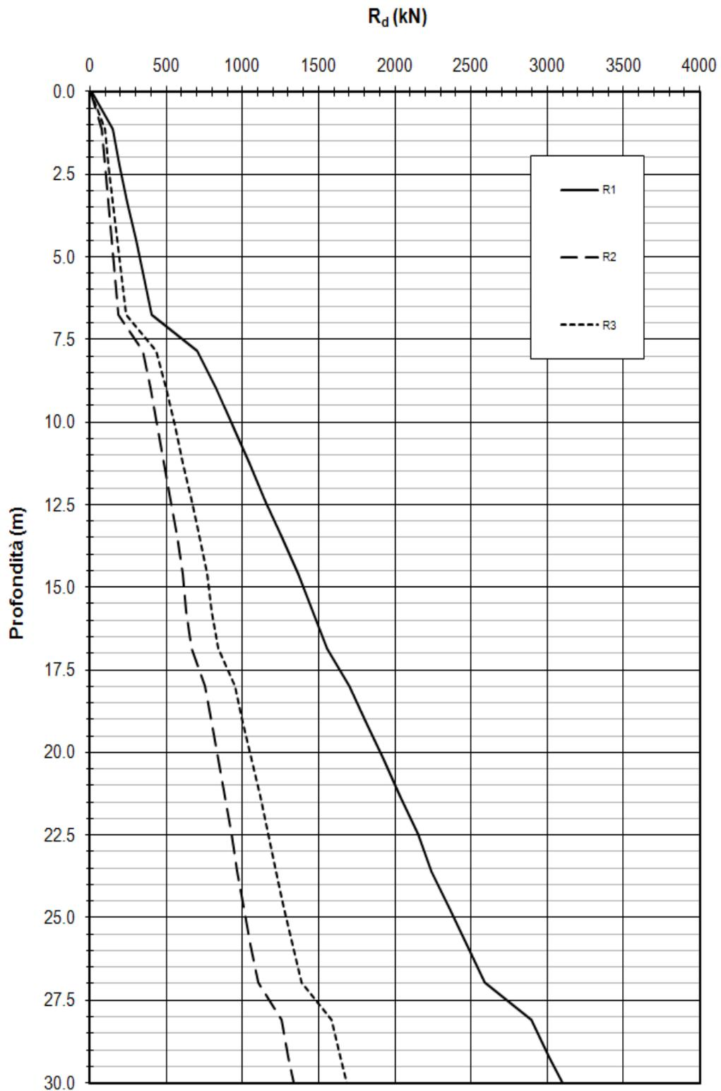
**Figura 10-5: Pali trivellati - Resistenza del palo a compressione – combinazione SLU-SIS**
