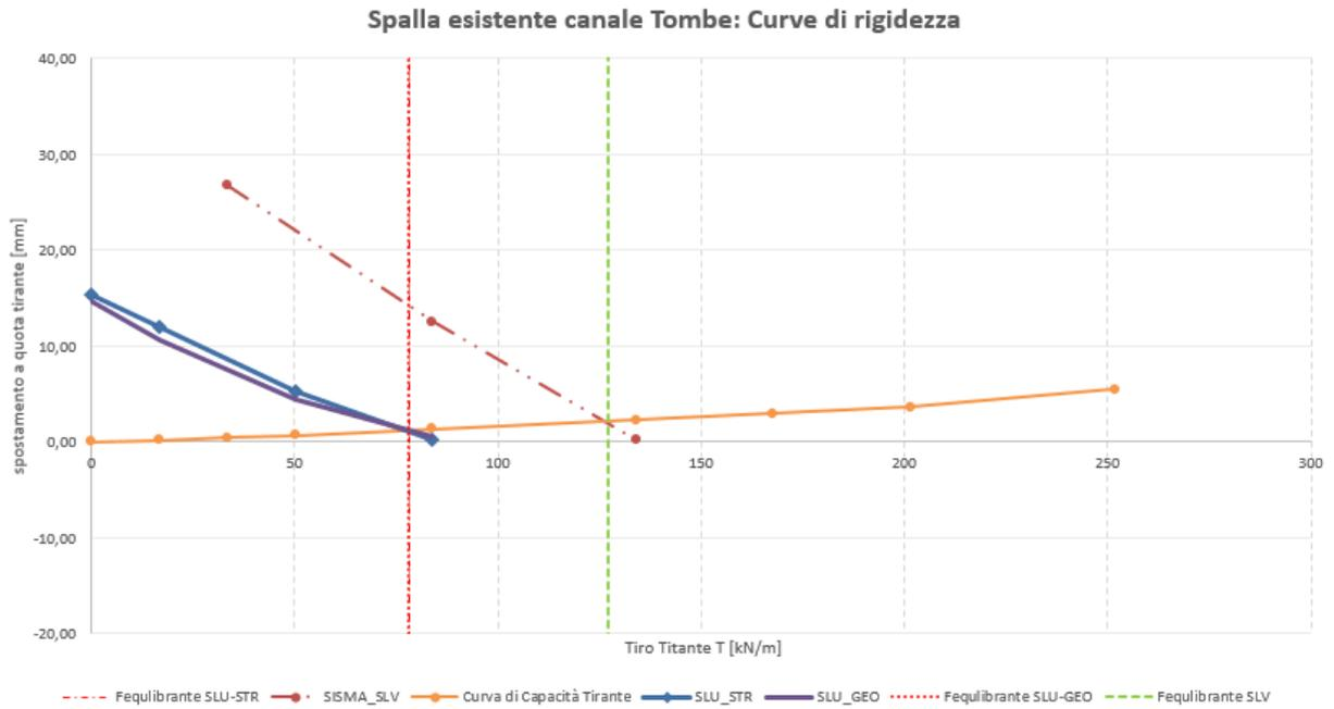
**Figura 6-1. Curva di interazione tra spalla e tiranti – comportamento fondazione spalla lineare**
