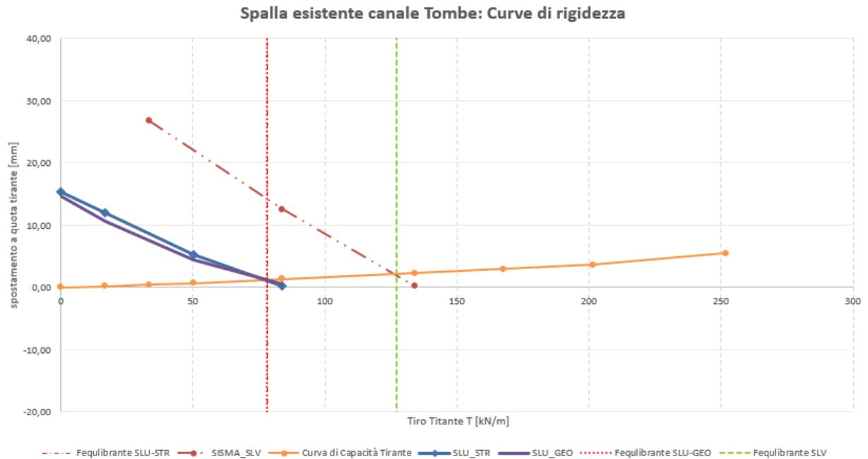
Figura 6-1 mostra un esempio del metodo ora illustrato; il punto di intersezione tra le curve di rigidezza del ritegno, e la curva di rigidezza della fondazione, determinato come descritto sopra, verifica la congruenza degli spostamenti ed indica il tiro a cui è soggetto il ritegno nella specifiche condizioni di carico analizzata.
