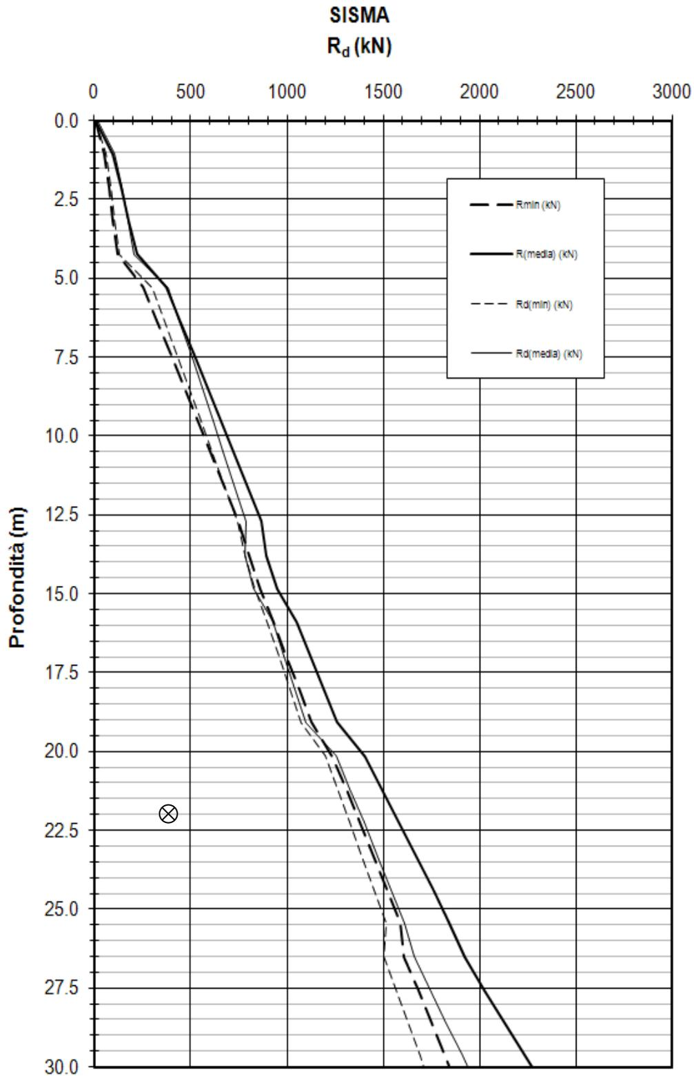
Figura 10-11: Pali esistenti - Azioni assiali massime a confronto con le resistenze di progetto R<sub>d</sub> per i pali esistenti soggetti a compressione – combinazione SLV
