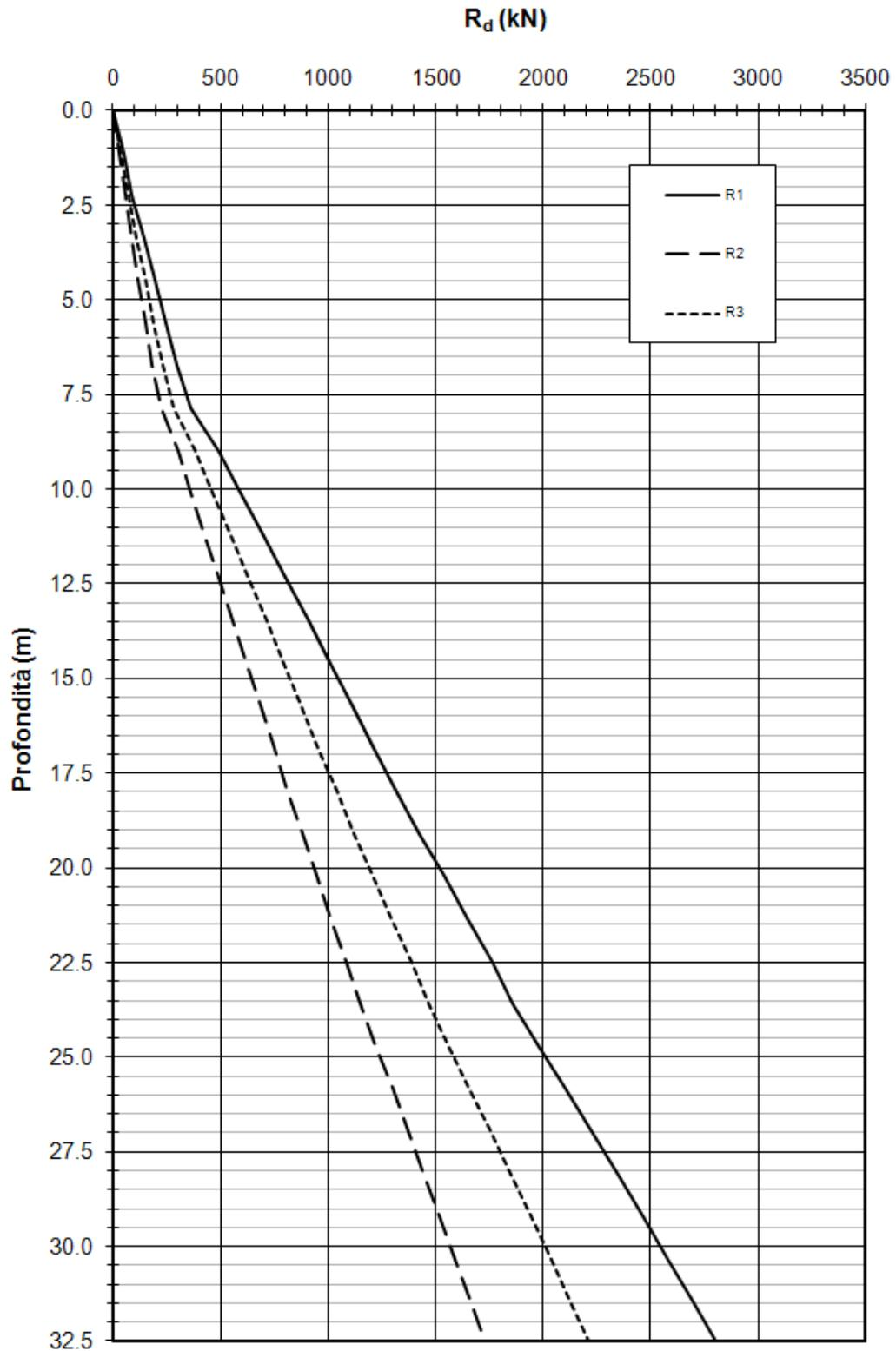
Figura 10-6: Pali trivellati - Resistenza del palo a trazione – combinazione SLU-SIS
