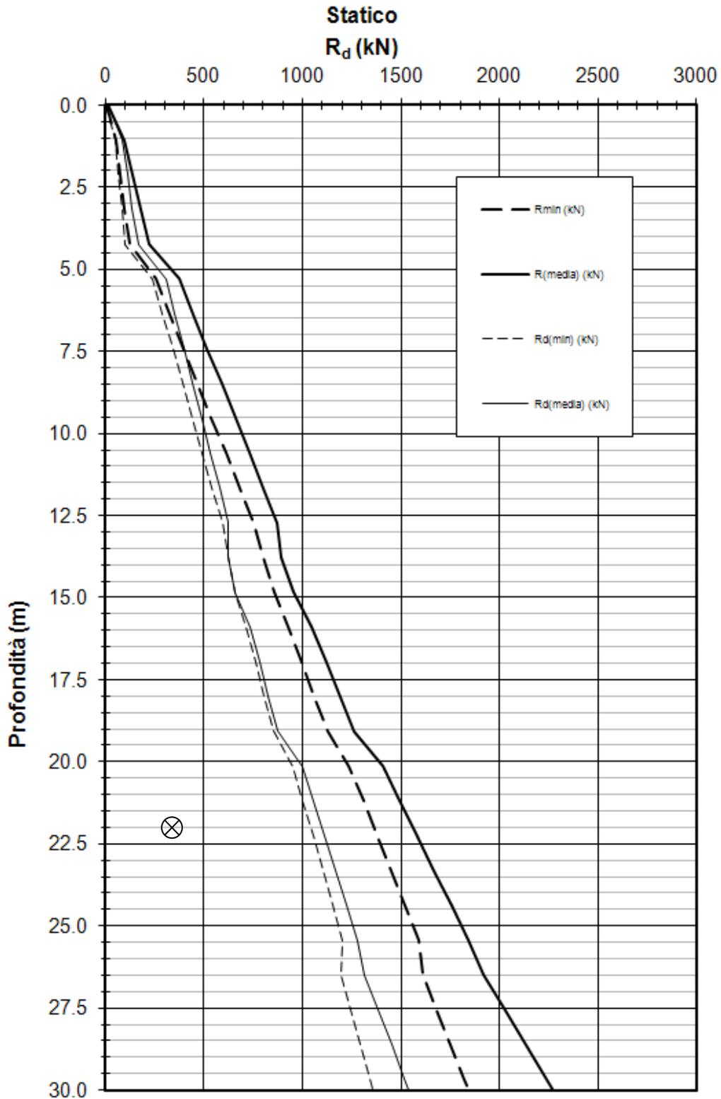
Figura 10-10: Azioni assiali massime a confronto con le resistenze di progetto  $R_d$  per i pali esistenti soggetti a compressione – combinazione SLU-GEO
