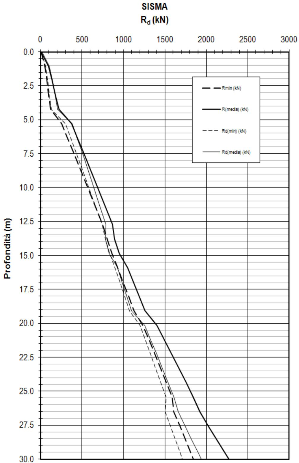
Figura 10-2: Pali esistenti - Resistenza del palo a compressione – combinazione SIS
