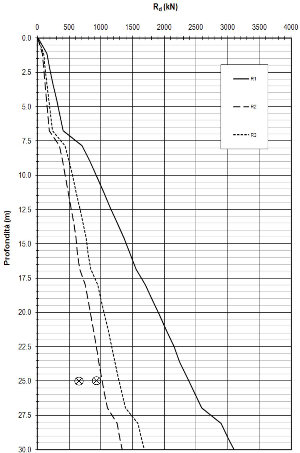
Figura 10-12: Azioni assiali massime a confronto con le resistenze di progetto  $R_d$  per i pali trivellati soggetti a compressione – combinazione SLU GEO ed SLV
