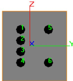
**Figura 10-9: Schema Group della palificata - ampliamento fondazione su pali trivellati**
