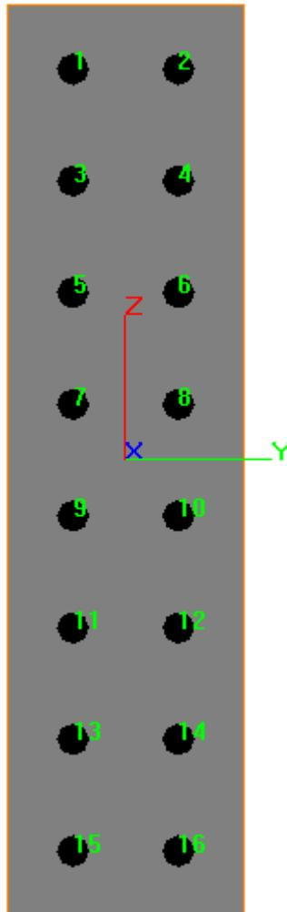
**Figura 10-8: Schema Group della palificata - fondazione esistente(1/2 Spalla)**
