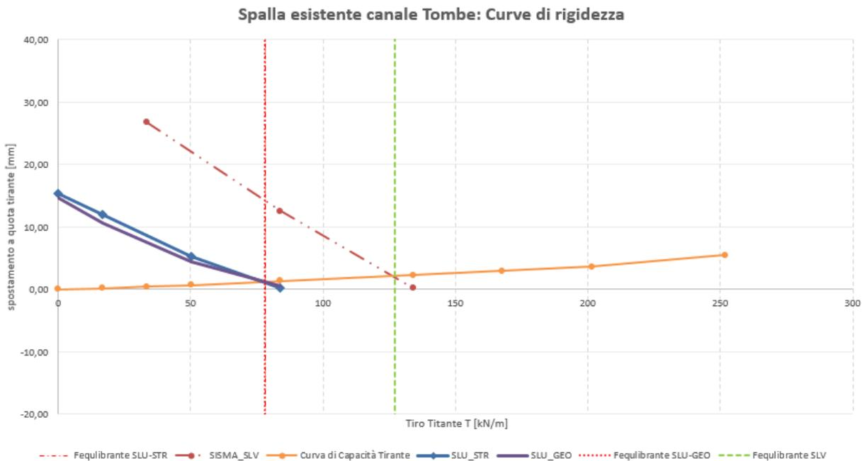
**Figura 10-7: Curva di Rigidezza Spalla Esistente – Ritegno Sismico**
