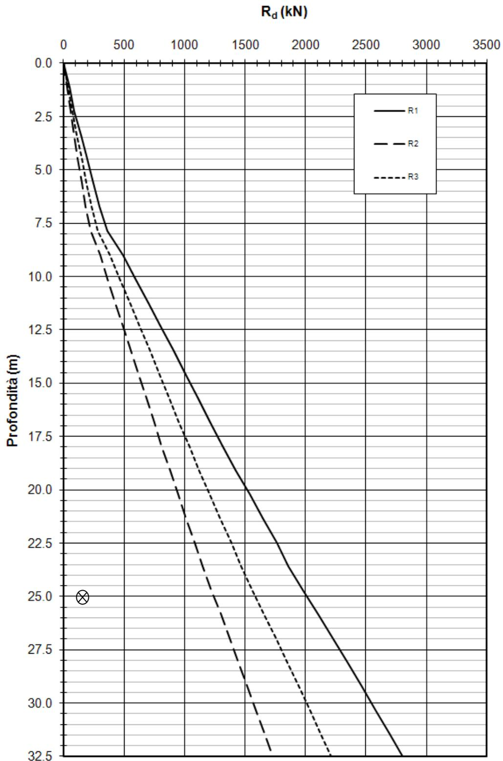
Figura 10-13: Azioni assiali massime a confronto con le resistenze di progetto  $R_d$  per i pali trivellati soggetti a trazione – combinazione SLU GEO e SLV
