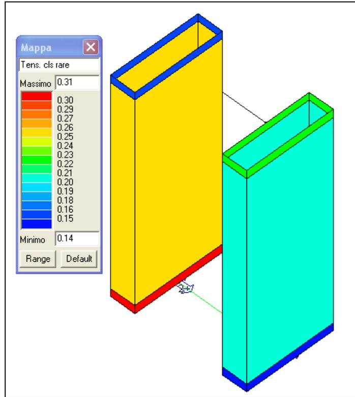
Figura 10-19 Verifica delle tensioni cls in esercizio (rara)
