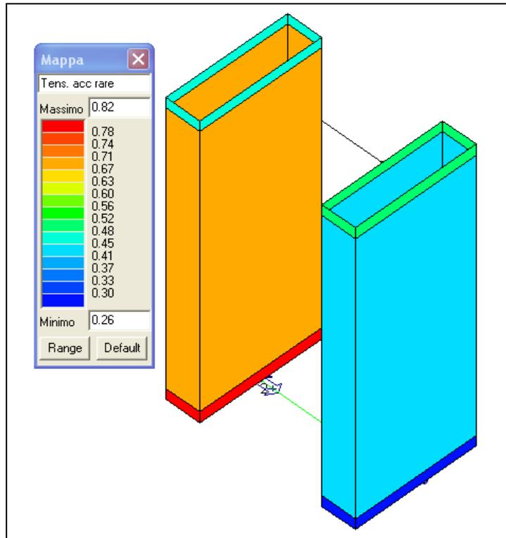
Figura 10-20 Verifica delle tensioni acciaio in esercizio (rara)
