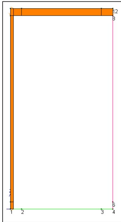
Figura 5-11 Carico veicoli tandem e  $9 \text{ kN/m}^2$  a tergo del piedritto sx e centrato
