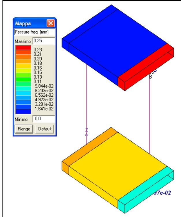
Figura 10-10 Verifica delle fessure nelle solette (frequente)
