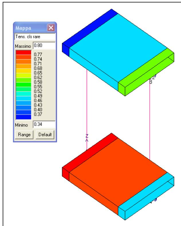
Figura 10-12 Verifica delle tensioni cls in esercizio (rara)
