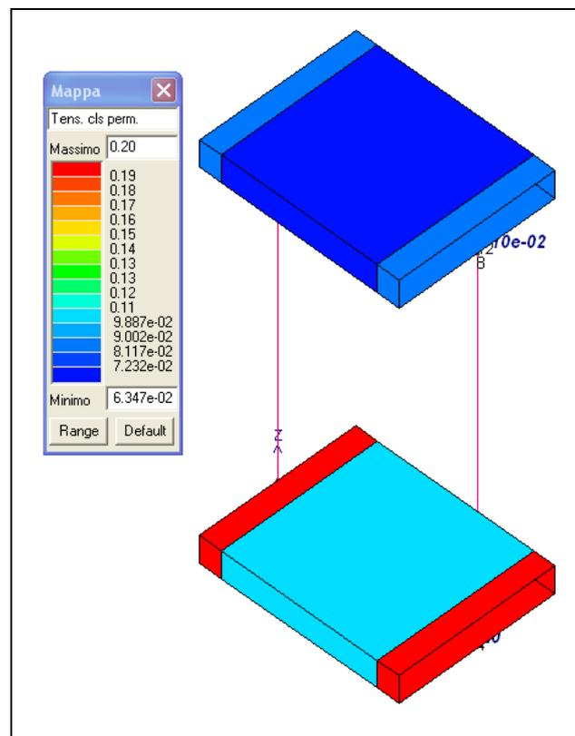
Figura 10-14 Verifica delle tensioni cls in esercizio (permanente)
