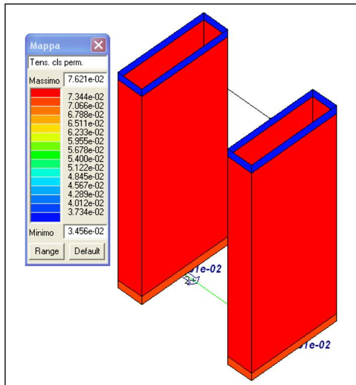
Figura 10-21 Verifica delle tensioni cls in esercizio (permanente)
