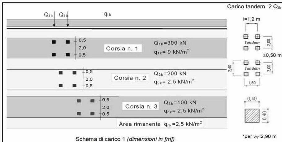
Figura 9-1 Schema di carico 1 (fig. 5.1.2 D.M. 2008)
