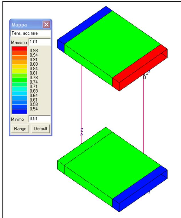
Figura 10-13 Verifica delle tensioni acciaio in esercizio (rara)
