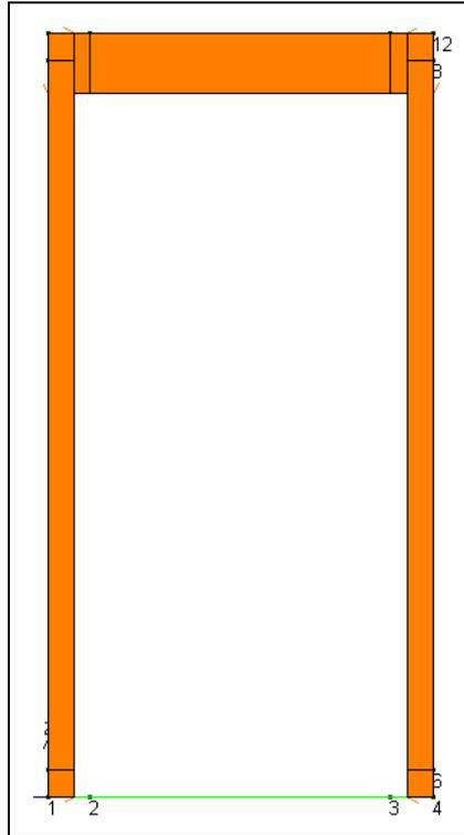
Figura 5-3 Carico veicoli uniforme 20 kN/m<sup>2</sup> (sovraccarico stradale sopra scatolare)
