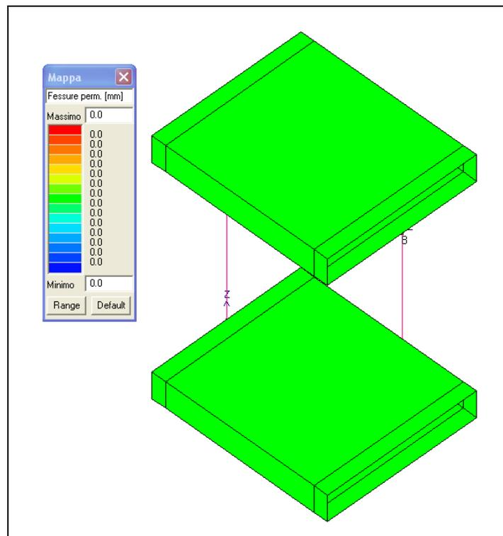
Figura 10-11 Verifica delle fessure nelle solette (quasi permanente)
