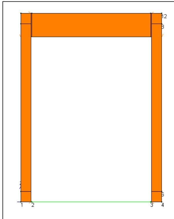
Figura 5-3 Carico veicoli uniforme 20 kN/m<sup>2</sup> (sovraccarico stradale sopra scatolare)
