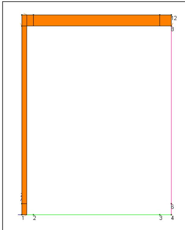
Figura 5-11 Carico veicoli tandem e  $9 \text{ kN/m}^2$  a tergo del piedritto sx e centrato
