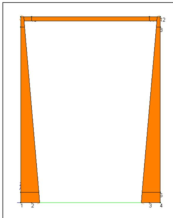
Figura 5-2 Carico permanente portato (rilevato e carreggiata stradale)
