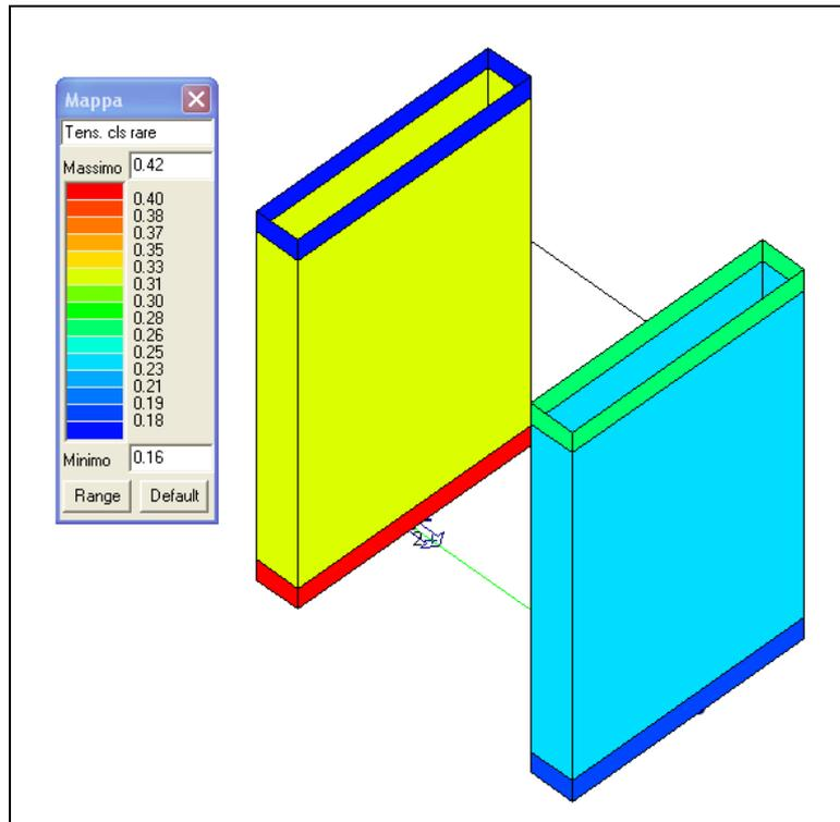
Figura 10-19 Verifica delle tensioni cls in esercizio (rara)
