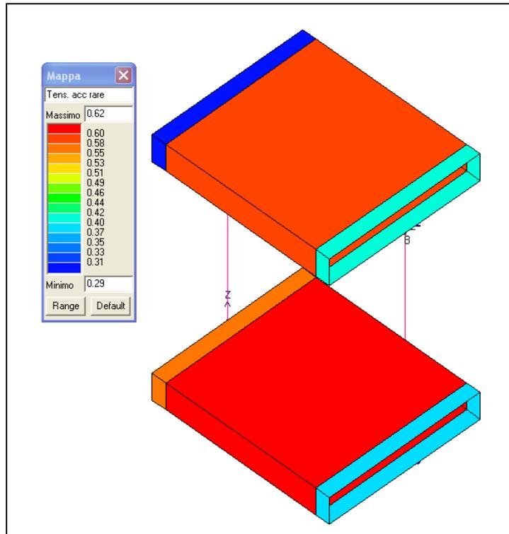
Figura 10-13 Verifica delle tensioni acciaio in esercizio (rara)
