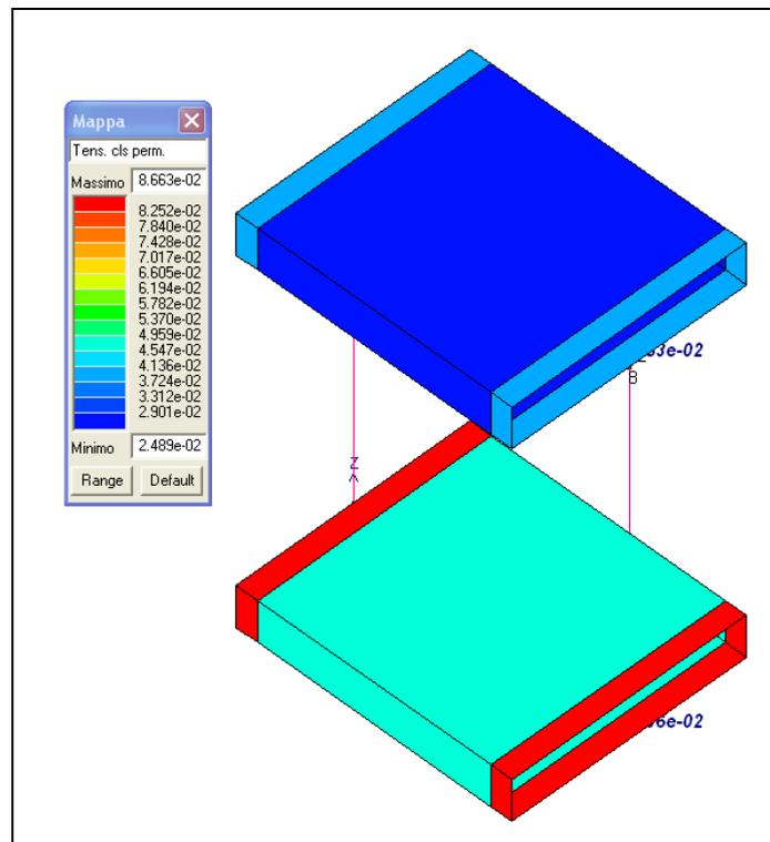
Figura 10-14 Verifica delle tensioni cls in esercizio (permanente)
