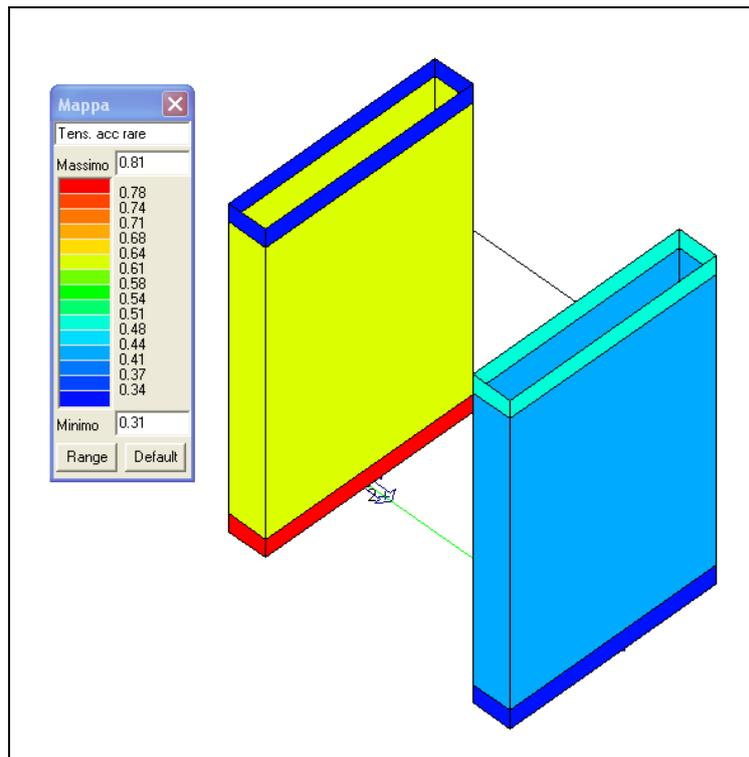
Figura 10-20 Verifica delle tensioni acciaio in esercizio (rara)
