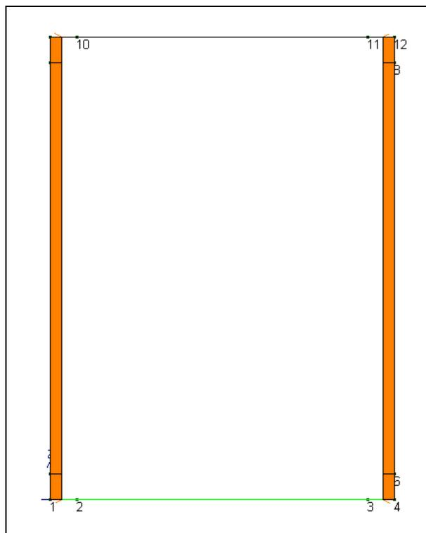
Figura 5-10 Carico veicoli tandem e 9 kN/m<sup>2</sup> a tergo del piedritto sx e dx
