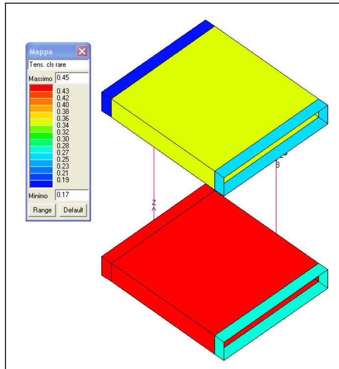
Figura 10-12 Verifica delle tensioni cls in esercizio (rara)
