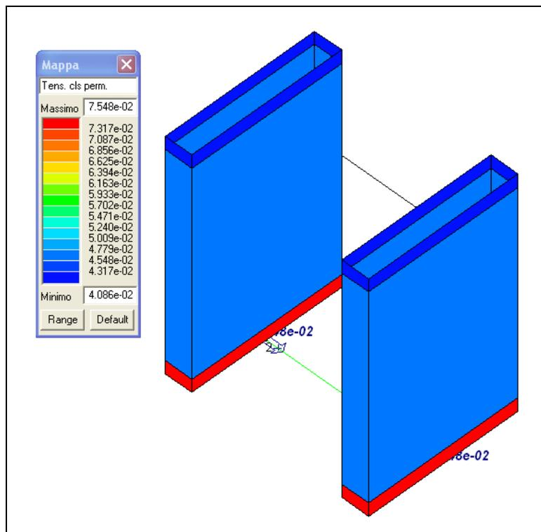
Figura 10-21 Verifica delle tensioni cls in esercizio (permanente)
