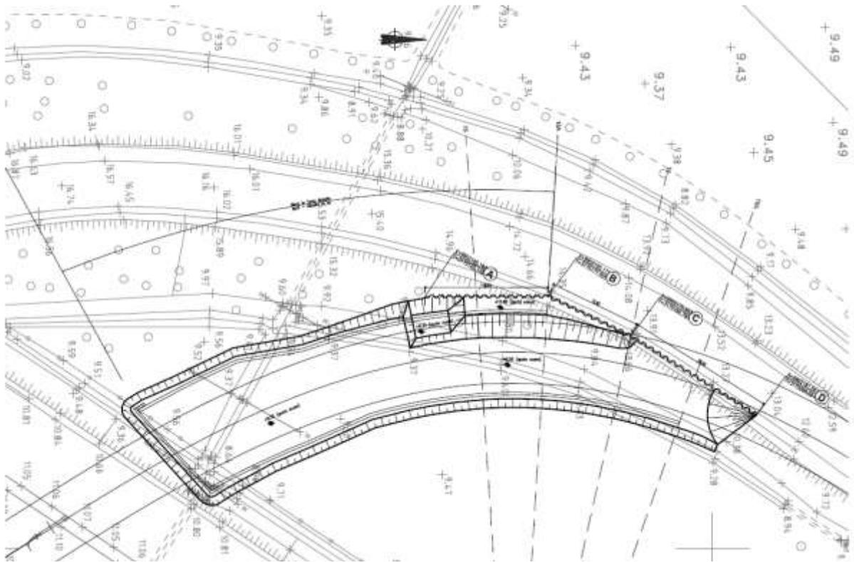
Figura 2- Muro spalla B: sviluppo in pianta palancola
