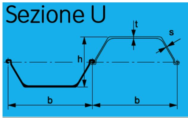
**Figura 10 - Caratteristiche del profilo minimo PU22**
