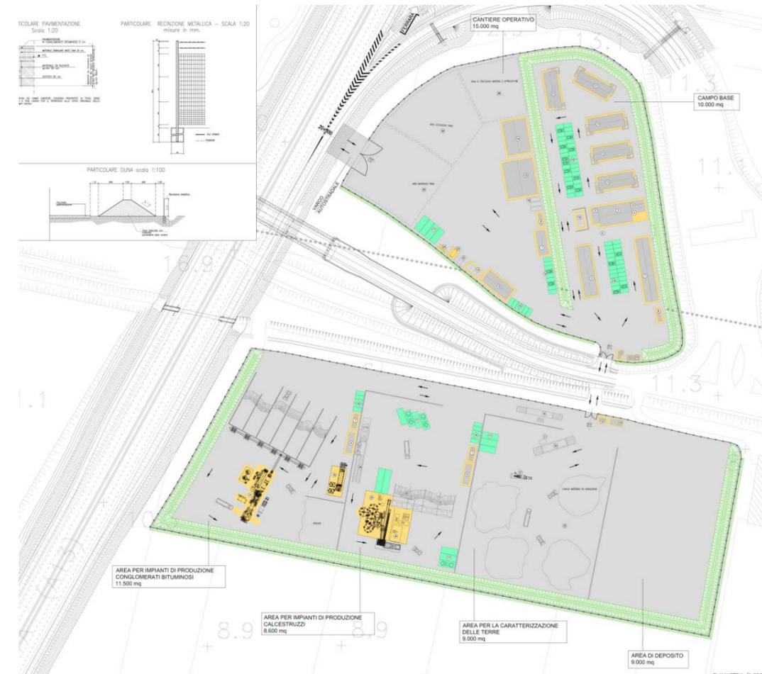
Figura 1-56 Planimetria layout di cantiere CB01.
