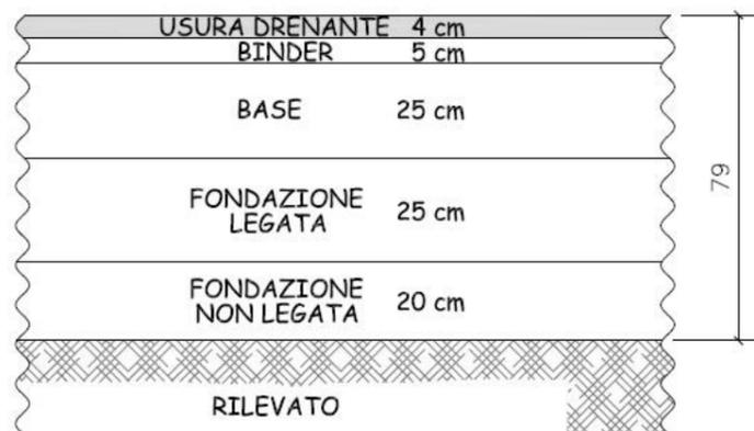
La pavimentazione esistente presenta uno spessore complessivo pari a 49cm con una sovrastruttura così composta:
