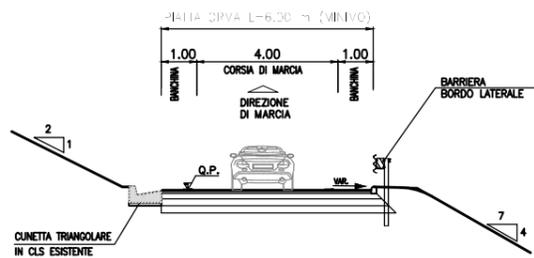
SEZIONE TIPO RAMPA DI
