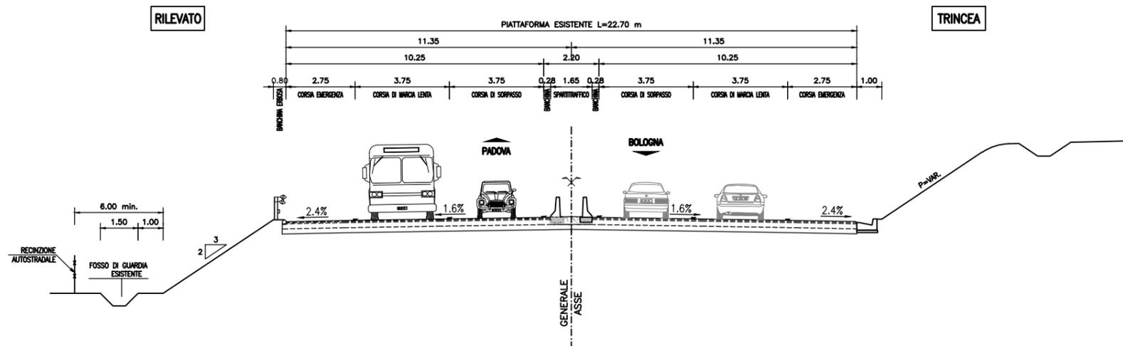
SEZIONE TIPO DI PROGETTO IN RETTIFILO
