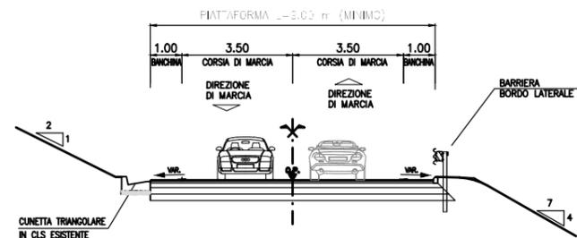
SEZIONE TIPO RAMPA DI
