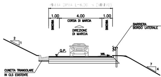
SEZIONE TIPO RAMPA DI
