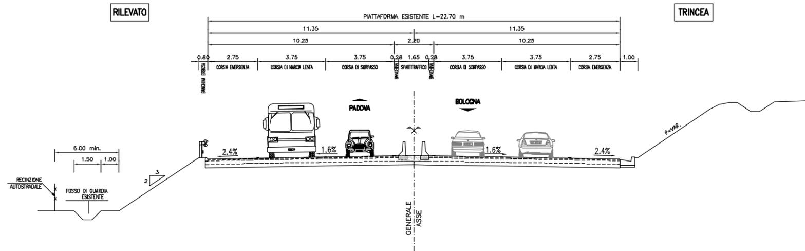
SEZIONE TIPO DI PROGETTO IN RETTIFILO
