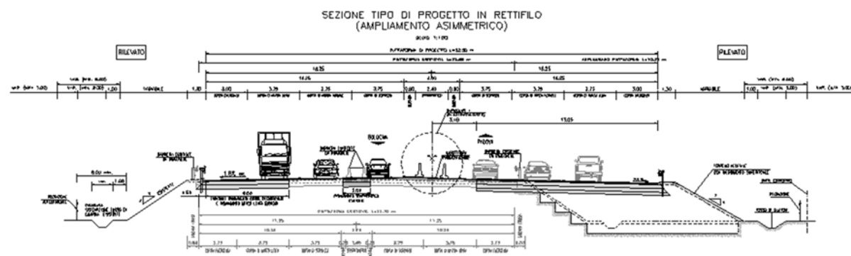
Figura 2—4 Sezione tipo ampliamento III corsia (ampliamento asimmetrico)
