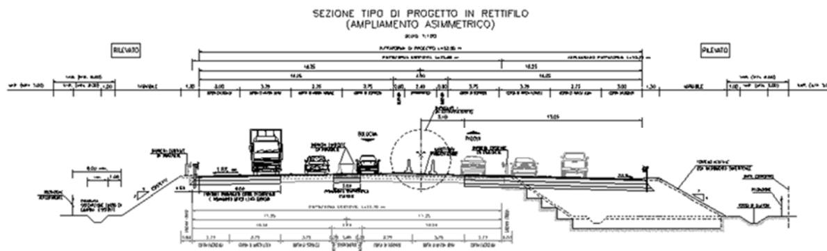
Figura 3—2 Sezione tipo ampliamento terza corsia (ampliamento asimmetrico)
