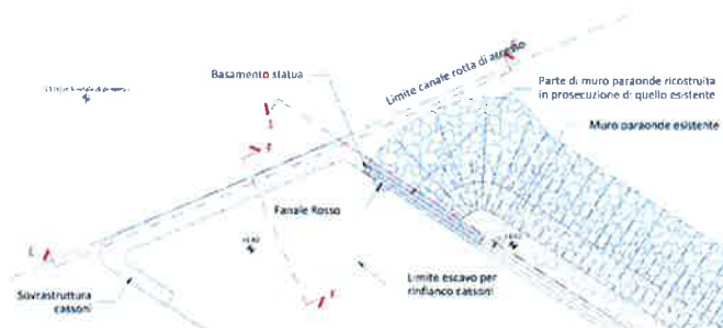
Figura 8 – planimetria di progetto resecazione molo di levante
