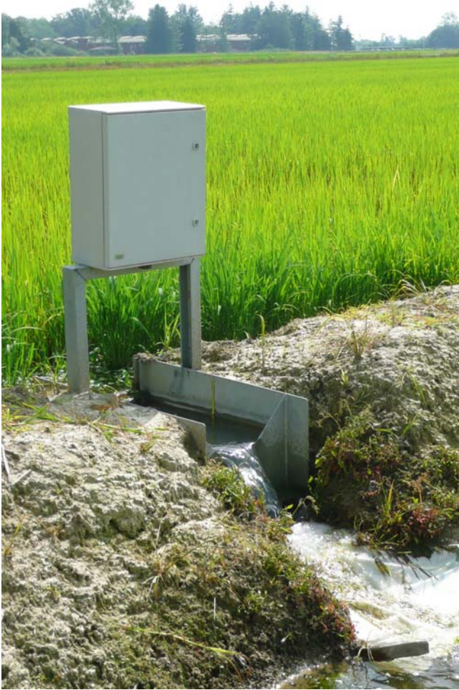
Esempi di monitoraggio delle portate transitanti tra gli arginelli delle singole camere o lungo canali di alimentazione, mediante misuratore di livello.
