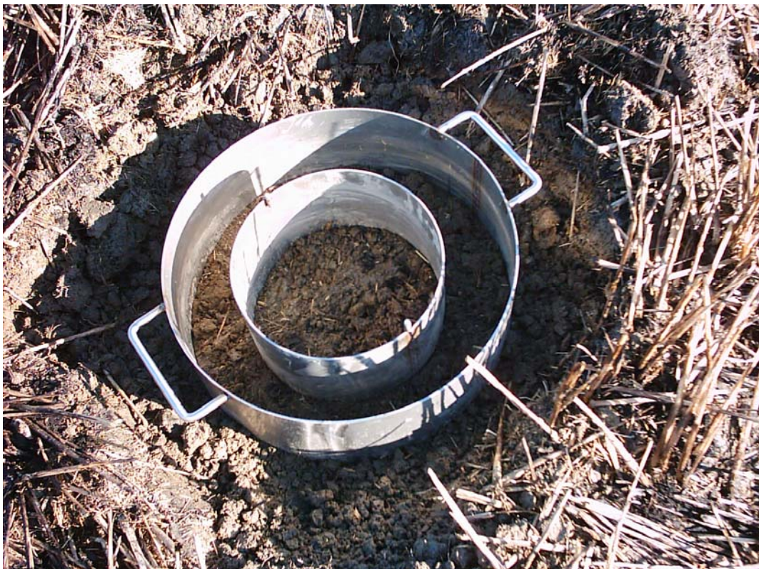
Particolare di doppio cilindro infisso nel terreno: la prova sperimentale avviene monitorando il comportamento dell'acqua nel cilindro interno, mentre quello esterno viene riempito e mantenuto ad un livello d'acqua costante per simulare le condizioni di sconfinamento.
