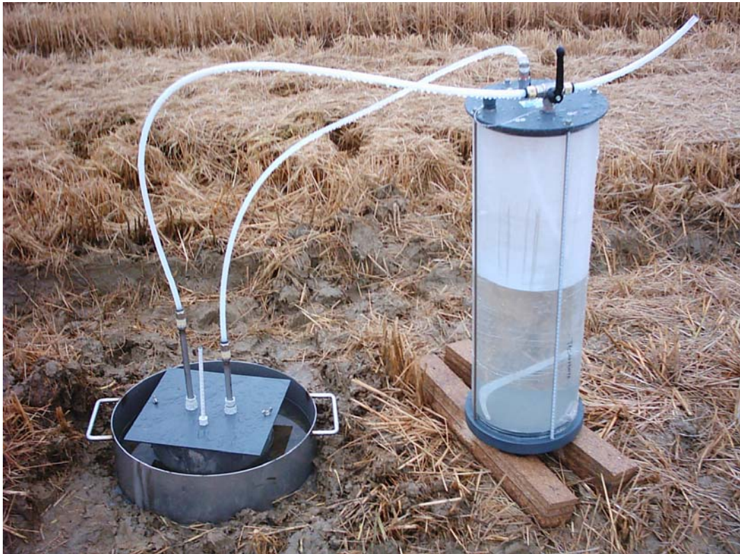
Prova di permeabilità del suolo mediante doppio anello e serbatoio di alimentazione annesso.
