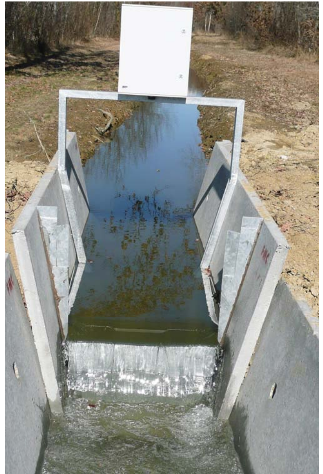
Esempi di monitoraggio delle portate transitanti tra gli arginelli delle singole camere o lungo canali di alimentazione, mediante misuratore di livello.
