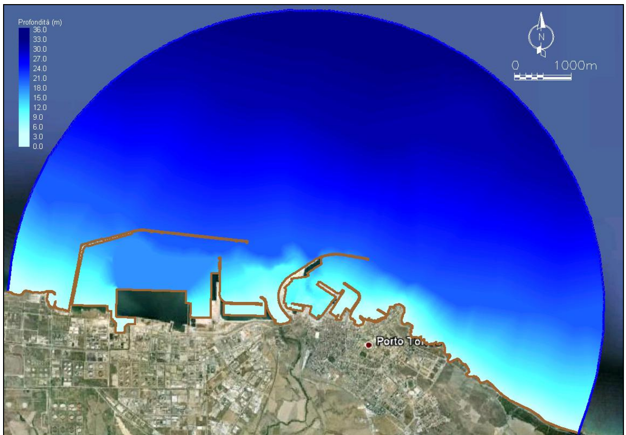
Figura 2.2 – Configurazione di PRP 2011: batimetria di riferimento utilizzata per le simulazioni con il modello CGWAVE.
